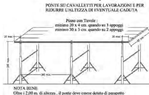
Non depositare materiale in eccesso sul ponte ma solo il materiale strettamente necessario per la lavorazione in corso. È necessario mantenere il materiale in ordine e garantire un transito sicuro sull'impalcato. Evitare i carichi concentrici sul ponte ma ripartire il peso del materiale. Non sostare in più persone in uno stesso punto dell'impalcato e non saltare
