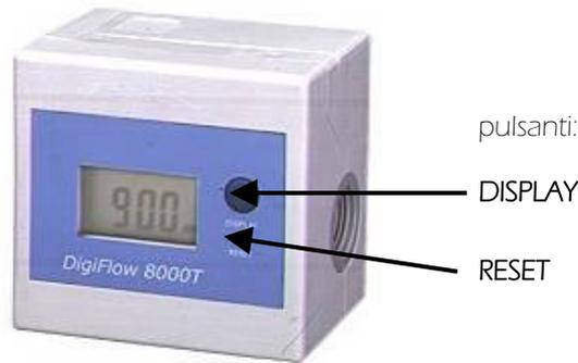
Il contatore digitale Cillit-Digimeter è un contatore per acqua fredda potabile in esecuzione chiusa. Il sistema è dotato di una piccola turbina collegata ad un sensore magnetico per il rilevamento della portata, di un display e due pulsanti. L'apparecchio è autonomo, estremamente compatto, si installa in "linea" con l'impiego di raccordi di connessione di ingresso e uscita da 3/8" NPT femmina.
