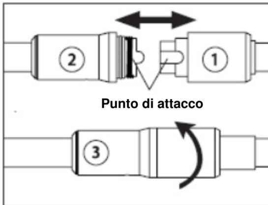
1. Rimuovere il cappuccio dal punto di collegamento dell'endoscopio.
