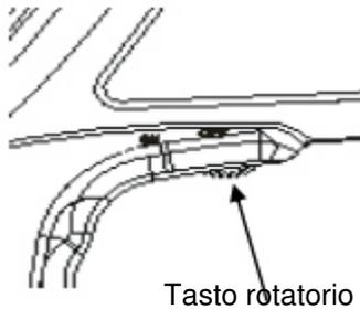
1. Ruotare l'interruttore verso l'impugnatura per accendere l'endoscopio.
