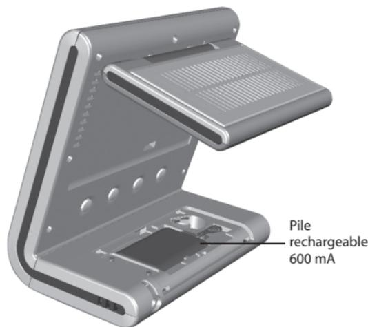
Si la pile rechargeable est presque vide, le voyant LED situé sur l'appareil principal et l'icône ☼ clignoteront. Exposez le panneau solaire directement face au soleil pendant approximativement 5 à 6 heures pour recharger la pile. La durée de vie de la pile sera d'environ 2 mois.
