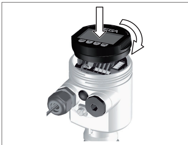
Figura 15: Installare il tastierino di taratura con display
