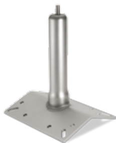
MVS028D H 300mm MVS029D H 400mm MVS030D H 500mm Torretta di colmo 20° Base 300x240x8mm Materiale: Acciaio Inox AISI 304
