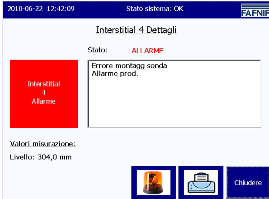
Figura 17: Schermata Dettagli sonda Interstitial 4, con stato allarme
