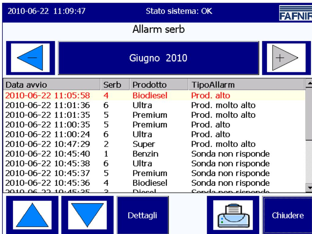
Figura 7: Prospetto degli allarmi serbatoio
