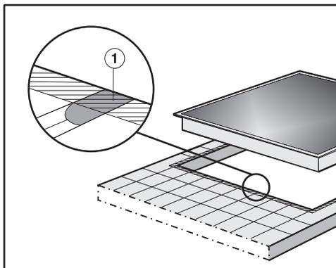
Le fessure ① e l'area tratteggiata sotto la superficie d'appoggio del piano di cottura devono essere lisce e perfettamente in piano affinché il piano poggi uniformemente e la guarnizione applicata sotto il bordo della parte superiore dell'apparecchio possa garantire una tenuta sufficiente verso il piano di lavoro.
