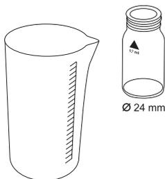
Predisporre due cuvette pulite da 24 mm.
