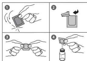
1. Aprire una cuvetta per reagenti chiusa con tappo bianco e riempirla con **0,1 ml di acqua completamente desalinizzata** (cuvetta per lo zero).
