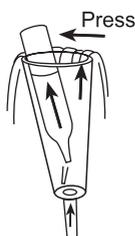
5. Una volta che il contenitore è completamente lavato premere un'ampolla Vacu-vials® in uno degli angoli in basso del contenitore del campione. Aumentando lievemente la pressione la punta dell'ampolla si rompe. Il campione di acqua riempie l'ampolla. Nell'ampolla rimane un volume ridotto di gas inerte.
