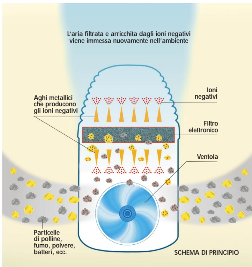
Tramite le feritoie l'aria carica di pollini, fumo e batteri viene aspirata dalla ventola incorporata a due velocità. L'aria aspirata viene caricata elettrostaticamente e quindi fatta passare attraverso un filtro che ne trattiene le impurità. L'aria filtrata, arricchita di ioni negativi, viene poi nuovamente immessa nell'ambiente provocando anche un'azione favorevole sulle funzioni dell'organismo.
