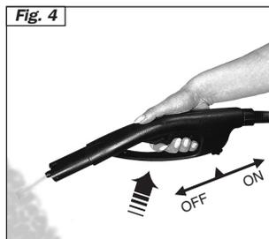
**NOTA:** l'interruttore caldaia (B) si accende e si spegne durante l'utilizzo di VAPORETTO. Questo indica che la resistenza elettrica entra in funzione per mantenere la pressione costante ed è quindi da considerarsi un fenomeno normale. Se durante l'utilizzo si provoca una torsione eccessiva della guaina, il dispositivo No-Volt interrompe il flusso di vapore. Per riprendere l'erogazione è sufficiente premere nuovamente la leva comando vapore.
