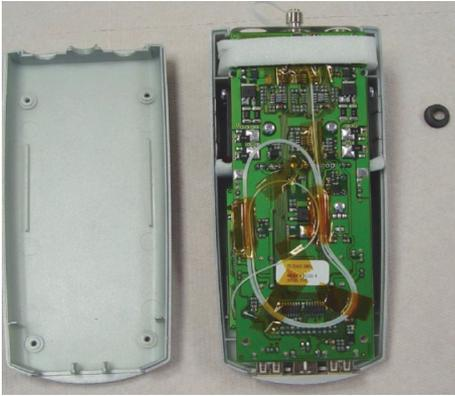
4. Rimuovere l'etichetta 5 (Pos. 4) e la parte inferiore dell'alloggiamento (Pos. 1).
