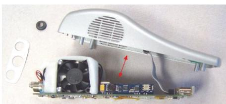
**16.** Collegare il connettore del cavo piatto e chiudere con cautela la parte superiore dell'alloggiamento (Pos. 8).
