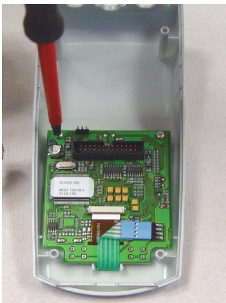
9. Allentare le due viti di fissaggio della scheda della CPU (Pos. 10).
