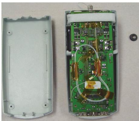
18. Inserire nuovamente la guarnizione rotonda in plastica della presa "DC-IN" (Pos. 5).
