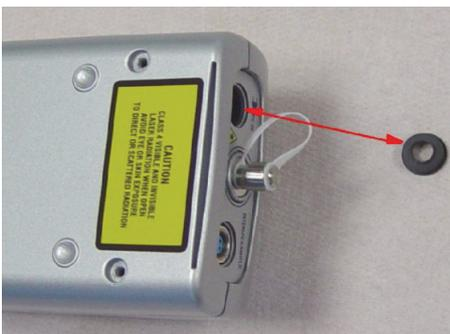
3. Rimuovere la guarnizione rotonda in plastica della presa "DC-IN" (Pos. 5).
