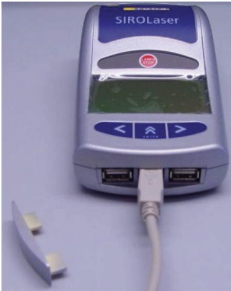
2. Quando l'apparecchio è spento e il connettore di rete è scollegato, collegare il SIROLaser alla presa RS232 del proprio PC collegando il connettore B USB con il SIROLaser e il connettore RS232 con il PC. Se il PC non ha una presa RS232, utilizzare un cavo di adattamento RS232 USB, reperibile nei negozi di informatica.
