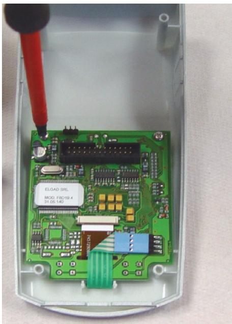
**14.** Fissare le due viti di fissaggio della scheda della CPU (Pos. 10).
