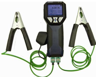
Imm. 4: Collegamento delle pinze temperatura
