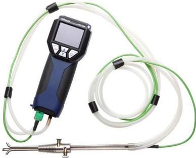
Imm. 35: Collegamento del tubo di misura tipo S al Wöhler DC 410
