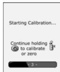
3. Il rilevatore entra in modalità di azzeramento. Mentre lo strumento azzerava tutti i sensori, sul display viene visualizzato **zeroing** (azzeramento in corso).
