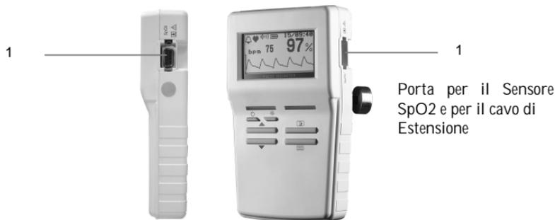
**Figure. 5** Porta per il sensore SpO2
