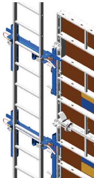
26. Fissaggio Scala XS a Frami 300
