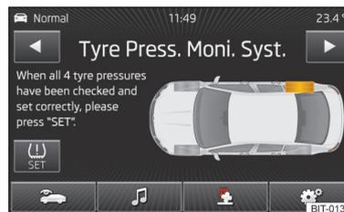
Fig. 28 Sistema di controllo della pressione pneumatici - Esempio dimostrativo: controllare lo pneumatico posteriore destro e la sua pressione
