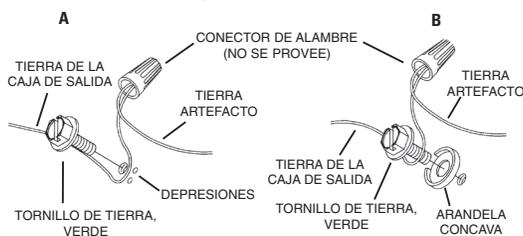
5) Haga las conexiones de los alambres (no se proveen los conectores.) La tabla de referencia de abajo indica las conexiones correctas y los alambres correspondientes.
