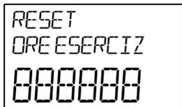
Questo reset viene eseguito, qualora sia stata compiuta una manutenzione nell'ambito dell'intervallo di manutenzione ("In base alla data" o "In base alle ore di esercizio"). In tal modo le ore di esercizio del bruciatore per il successivo intervallo di manutenzione vengono azzerate.
