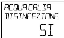
Inserire "SI". La disinfezione termica in base alle impostazioni di fabbrica parte ogni martedì alle ore 1:00 e riscalda l'acqua a 70 °C. Questi dati possono comunque essere adeguati alle esigenze dell'impianto.
