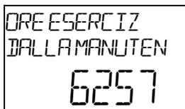
Con il parametro di visualizzazione "ORE DI ESERCIZIO DALLA MANUTENZIONE" è possibile rilevare le ore di esercizio effettive del bruciatore dall'ultima manutenzione, qualora sia stato impostata "Manutenzione dopo" = "Ore di esercizio".
