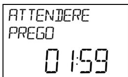
Il Reset è in corso di esecuzione. Il display, per un massimo di due minuti, mostra "ATTENDERE PREGO" e il tempo mancante per completare l'operazione in minuti e secondi.
