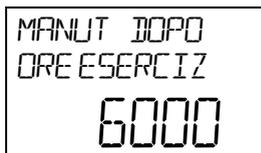
Selezionare, se l'appuntamento per la successiva manutenzione deve essere fissato in base alle ore di esercizio o alla data.
