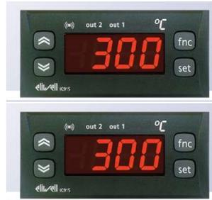
RUOTANDO IL SELETTORE IN FASE DI VERNICIATURA SI ACCENDE IL TERMOREGOLATORE N°1
