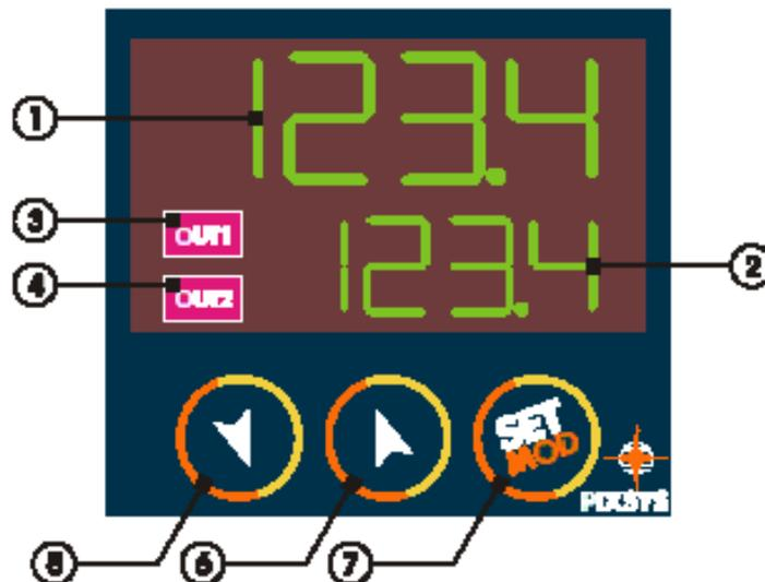
Scorrendo le frecce 5 e 6 si imposta la temperatura del Set Point 1 che viene visualizzata sul led 2. La temperatura per questa fase non può essere impostata a più di 20°25° C. Sul Set Point 1
