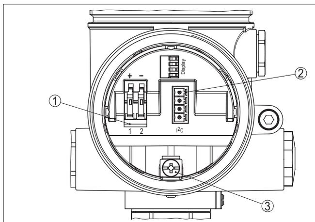
Figura 23: Vano di allacciamento custodia a due camere
