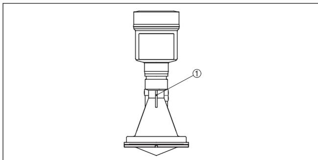
Figura 4: Posizione del piano di polirazzazione del VEGAPULS 67
