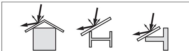
Figura 14: Copertura di profili piatti mediante deflettori
