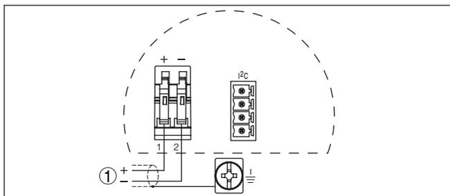
Figura 24: Schema di allacciamento custodia a due camere
