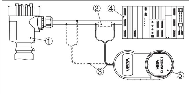
Figura 31: Collegamento del PC via HART alla linea del segnale
