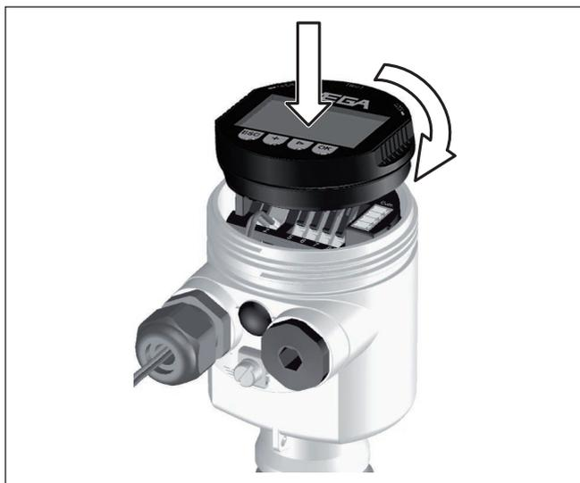
Figura 26: Installare il tastierino di taratura con display
