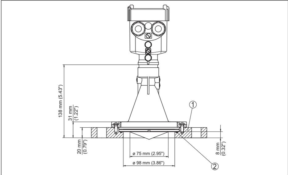
Figura 38: VEGAPULS 67, flangia d'adattamento DN 100/DN 150
