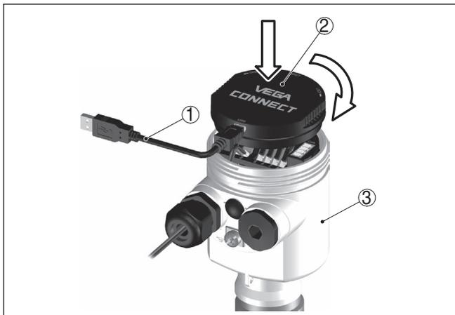
Figura 29: Collegamento diretto del PC al sensore via VEGACONNECT
