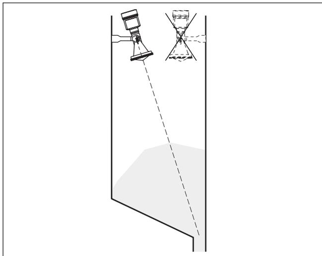
Figura 13: Installazione e orientamento in un silo a più sezioni
