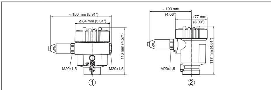
Figura 35: Le differenti custodie con grado di protezione IP 66/IP 68 (1 bar) - con tastierino di taratura con display incorporato l'altezza della custodia aumenta di 9 mm/0.35 in
