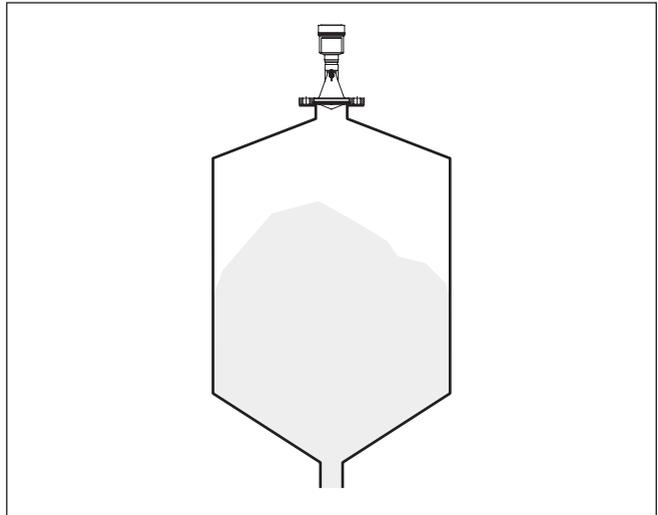
Figura 8: Montaggio con flangia del sensore radar
