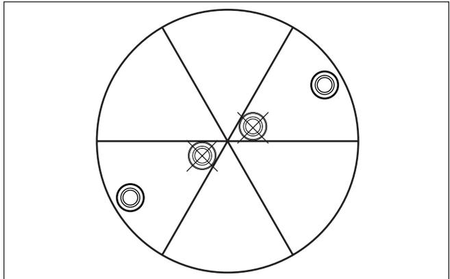
Figura 12: Installazione e orientamento in un silo a più sezioni
