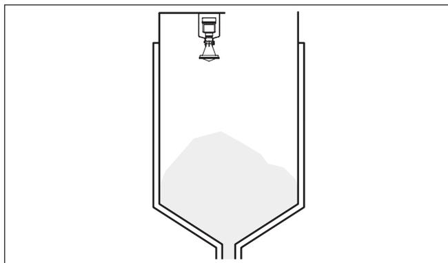
Figura 5: Sensore radar con staffa di montaggio
