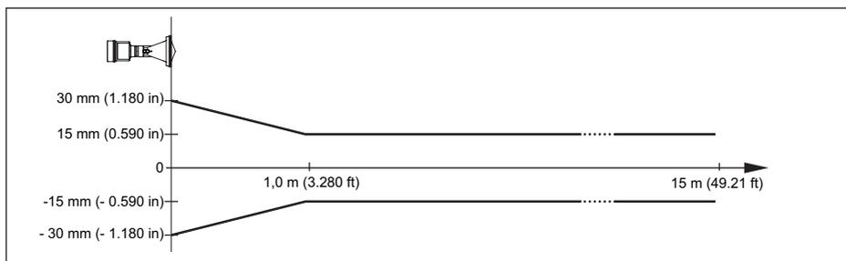
Figura 33: Scostamento di misura VEGAPULS 67
