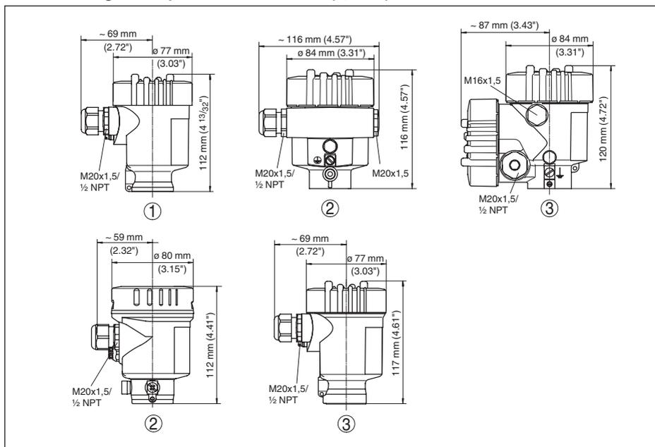
Figura 34: Le differenti custodie con grado di protezione IP 66/IP 68 (0,2 bar) - con tastierino di taratura con display incorporato l'altezza della custodia aumenta di 9 mm/0.35 in
