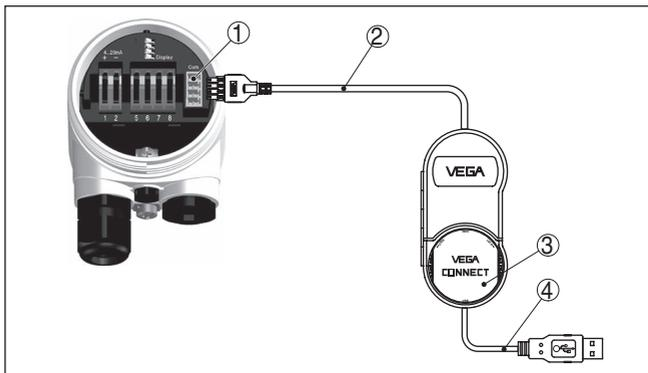
Figura 30: Collegamento via VEGACONNECT esterno
