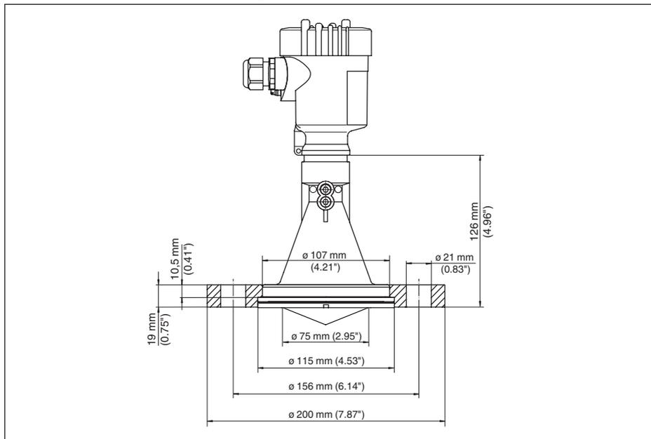
Figura 37: VEGAPULS 67, flangia di raccordo DN 80/3"/JIS80
