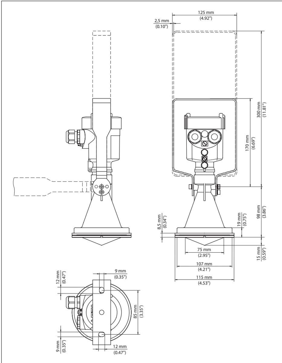
Figura 36: VEGAPULS 67, esecuzione con staffa di montaggio con lunghezza di 170 oppure 300 mm
