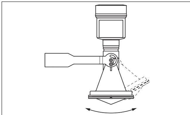
Figura 6: Regolazione dell'angolo d'inclinazione
