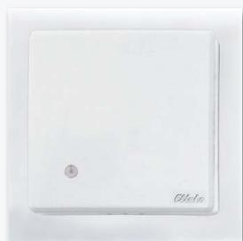
**Sensore wireless da interno – CO<sub>2</sub>+Temperatura+Umidità per il montaggio su serie civili 55x55 mm e 63x63 mm. Con display a LED regolato in base alla qualità aria d'ambiente e luminosità. Assorbimento in stand-by in media solo 0,4 Watt. Alimentazione 12V DC.**
