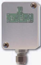
**Sensore crepuscolare wireless da esterno con attuatore, 60x46 mm, prof. 30 mm. Contatto 1NA 10A/250V non potenzialmente libero, lampade ad incandescenza 2000 Watt. Con wireless bidirezionale e funzione ripetitore attivabile. Assorbimento in stand-by solo 0,7 Watt.**
