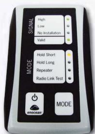
**Misuratore di livello EnOcean per facilitare l'installazione di sensori e attuatori wireless.**
