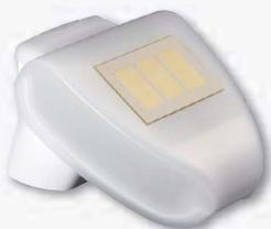
Il multisensore MS invia ogni secondo i dati meteo attuali rivelati, luminosità (da 3 punti cardinali), crepuscolo, vento, pioggia e temperatura esterna al trasmettitore dati meteo FWS61 collegato a valle. Per il collegamento è sufficiente un comune cavo telefonico J-Y (ST) Y 2x2x0,8 o simile. Lunghezza cavo massima 100m.
