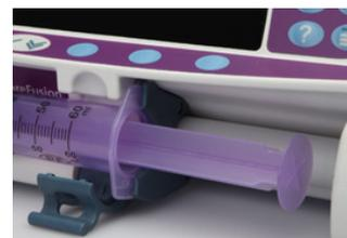
4. Sollevare il morsetto blocca siringa fino a bloccarlo sul cilindro della siringa.
