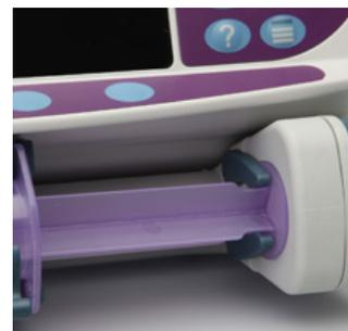
7. Verificare che il tipo e le dimensioni della siringa corrispondano a quelli visualizzati sulla pompa quindi premere **CONFIRM (CONFERMA)**. Se necessario, è possibile modificare il tipo di siringa premendo il tasto programmabile **TIPO**.
