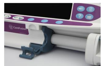
3. Inserire la siringa verificando che la flangia del cilindro sia correttamente alloggiata nel morsetto di fissaggio della flangia della siringa.
