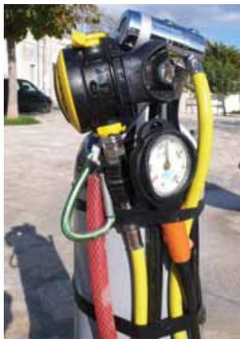
una autoerogazione accidentale comporti la perdita del gas di bailout contenuto nelle bombole. Conseguentemente per tutti gli erogatori delle bombole di Bail-Out dovrà essere utilizzata una valvola di sovrappressione sul primo stadio per evitare i dannosi effetti di un eventuale aumento della pressione intermedia che potrebbero comportare l'esplosione delle fruste di bassa pressione.
