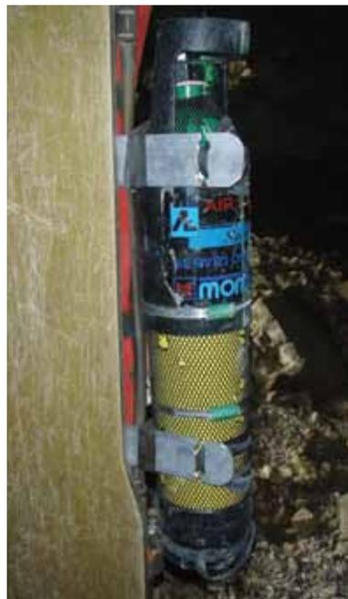
La bombola viene fissata su una doppia slitta metallica mediante elastici.
