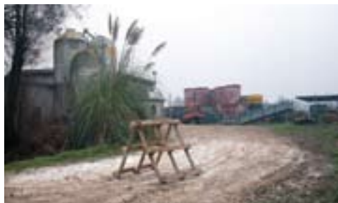
Esempio di barriera strutturale insufficiente
