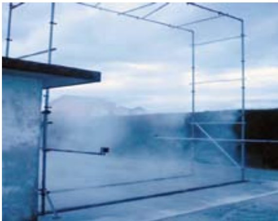
Arco di nebulizzazione per disinfezione automezzi
