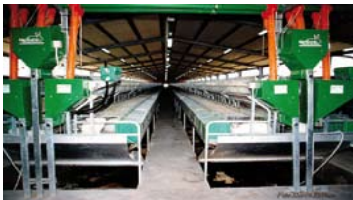
Figura 14. Distribuzione automatica del mangime
