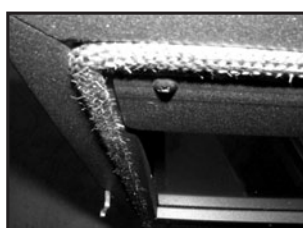
Immagine 8 Guarnizione del portello di carico in buone condizioni
