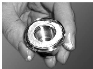
Fig. 38 Rondella Nord-Lock nel dado della girante
