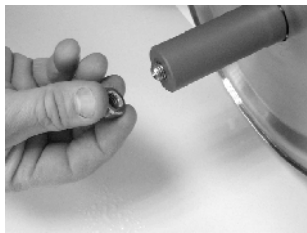
Fig. 22 Regolazione dell'albero pompa
