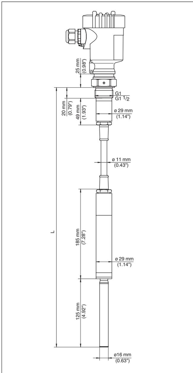
Figura 29: VEGAVIB 62 con cavo portante PUR
