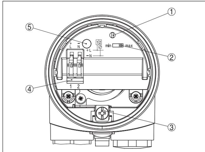
Figura 10: Vano dell'elettronica e di connessione - interruttore statico
