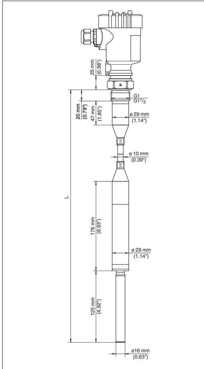
Figura 30: VEGAVIB 62 con cavo portante FEP
