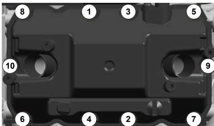
→ Sostituire le guarnizioni del coperchio della valvola (4) con parti nuove.
