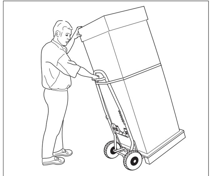
Fig. 14 *Trasportare la caldaia Logano G135(T) con l'imballaggio, sul pallet di trasporto, con la cinghia di fissaggio*
