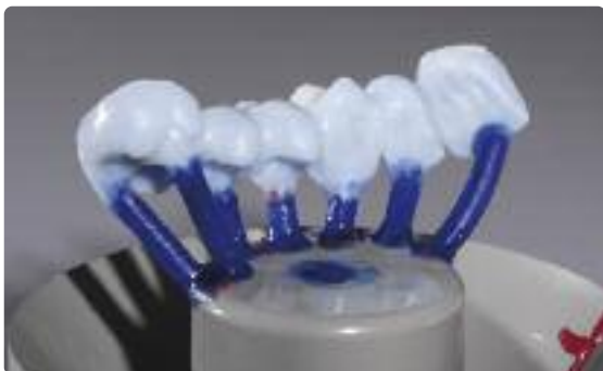
L'impernatura sulla base del cilindro avviene sempre in direzione del flusso della ceramica e nel punto più spesso.
