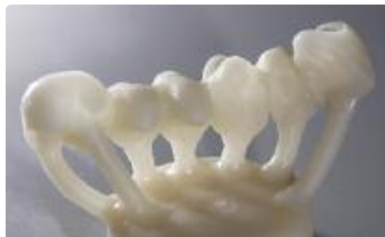
La smuffolatura grossolana avviene con perle per lucidatura a 4 bar di pressione, finché gli oggetti sono visibili. Eseguire la smuffolatura fine a 2 bar di pressione.
