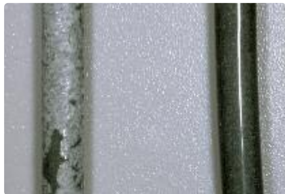
Termoelemento corrosivo (sinistra). Ripetere la cottura di pulizia finché la superficie del termoelemento è privo di impurità ed ha un aspetto vetroso (destra).
