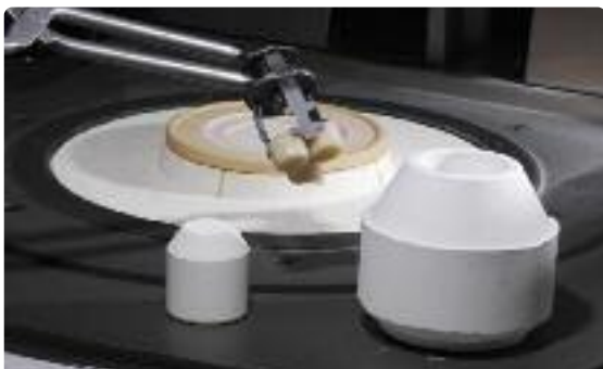
Dopo il ciclo di preriscaldamento completare il cilindro caldo con il grezzo freddo ed il pistone monouso IPS One-Way-Plunger 300 g ed eseguire la pressatura.
