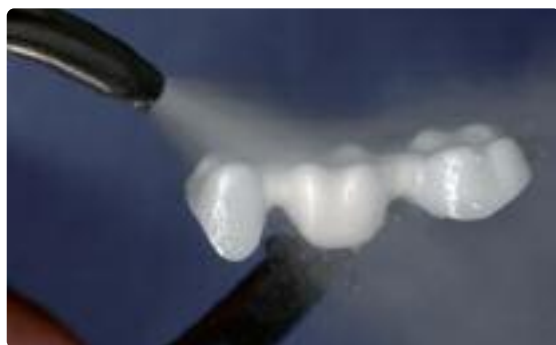
Prima del rivestimento estetico vaporizzare la struttura IPS e.max ZirCAD.
