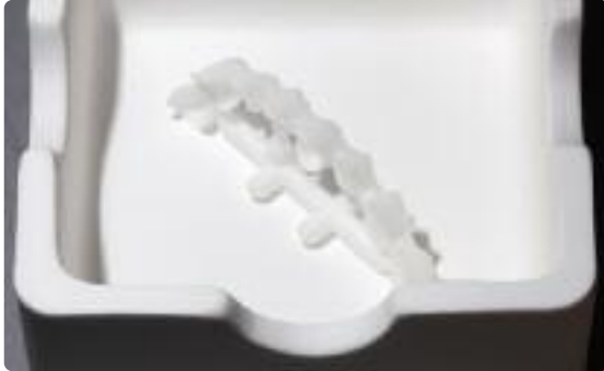
Al termine del processo di sinterizzazione, lasciare raffreddare il restauro a temperatura ambiente.
