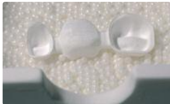
Prestare attenzione affinché la struttura sia correttamente supportata.
