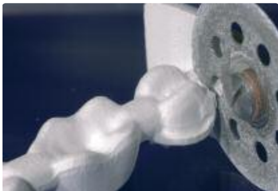
Separare cautamente la struttura limata dal supporto mediante disco separatore.
