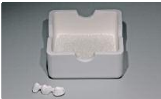
Contenitore di sinterizzazione riempita con 100 g di sfere di sinterizzazione ZrO_2 .
