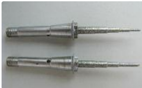
Per la lavorazione dei blocchi grandi utilizzare gli strumenti monopezzo.
