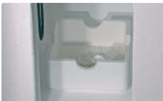
Posizionare il contenitore per sinterizzazione secondo i perni di orientamento.
