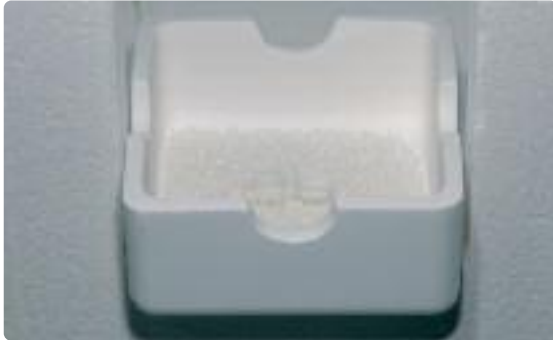
Al termine del processo di sinterizzazione, lasciare raffreddare il contenitore di sinterizzazione a temperatura ambiente e prelevarlo dal Sintramat.
