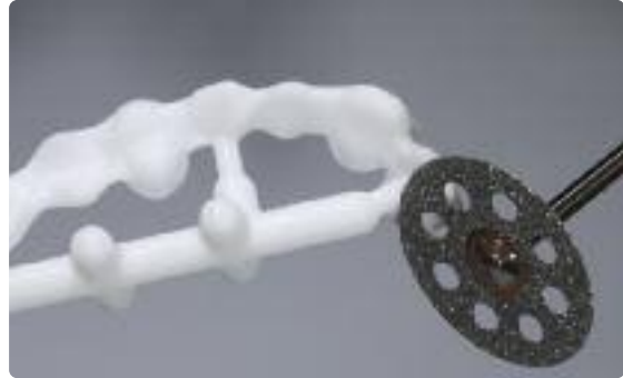
Separare la struttura di sinterizzazione con disco diamantato e bagnando costantemente la zona.
