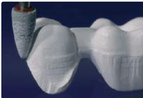
Rifinire la struttura non sinterizzata mediante adeguati strumenti per rifinitura.
