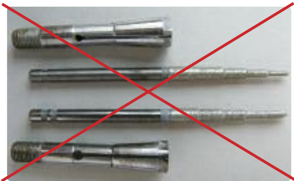
Non si devono utilizzare strumenti bloccati nel portamandrino.
