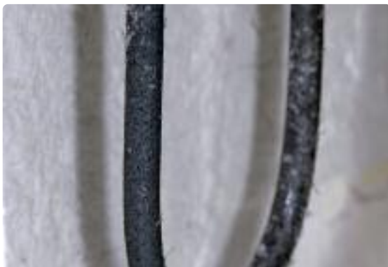
Termoelemento imbrattato, fortemente corrosivo.
