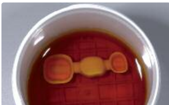
Immergere per 2 minuti nel Colouring Liquid per ottenere la penetrazione di uno spessore di \geq 0,7 mm.
