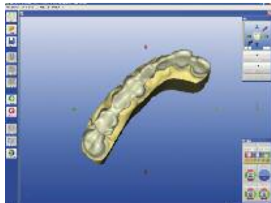
Adattare la proposta di struttura con gli appositi strumenti (Design Tools) alla situazione clinica. Rispettare gli spessori minimi e delle connessioni.
