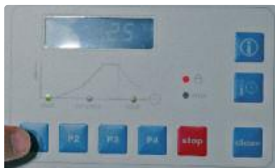
Premere il tasto "P1". Il programma si avvia e lo sportello del forno si blocca automaticamente.
