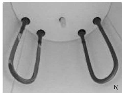
Sul termoelemento di sinistra si è staccato lo strato di protezione. Il termoelemento di destra è in buono stato, stabile e con uno strato di ossido / di protezione intatto. Ripetere la cottura di pulizia finché la superficie è nuovamente priva di impurità ed appare vetrosa.
