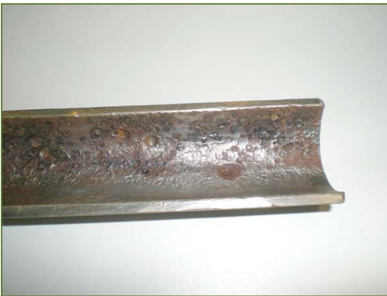
FIGURA 2 - Stato della superficie interna della tubazione dopo trattamento con acido cloridrico al 10%
