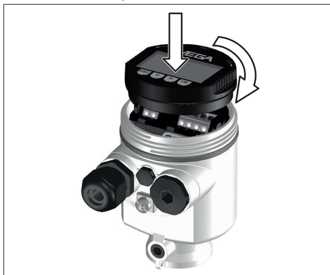
Figura 35: Inserimento del tastierino di taratura con display nel vano dell'elettronica in caso di custodia ad una camera
