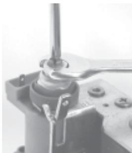
**Effettuare la regolazione pot. min. bloccando la posizione del dado "C" con chiave da 10 mm per evitare starature, ed agire con cacciavite a stella sulla vite "B".**
