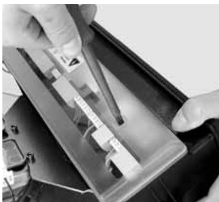
Figura 5-4 Allentamento delle viti della copertura del quadro di comando
