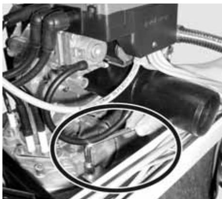
Figura 5-7 Allentare la vite di fissaggio del supporto della canalina dei cavi
