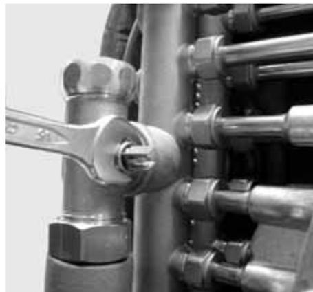
Figura 5-11 Staccare la spina della sonda di temperatura di mandata    Figura 5-12 Svitare ed estrarre la sonda di temperatura di mandata
