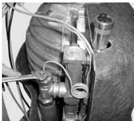
Figura 5-3 Rimozione del tubo capillare del manometro
