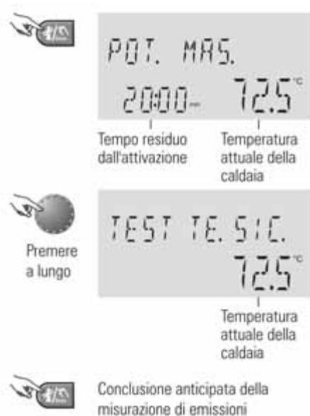
Figura 4-2 Collaudo del termostato di sicurezza
