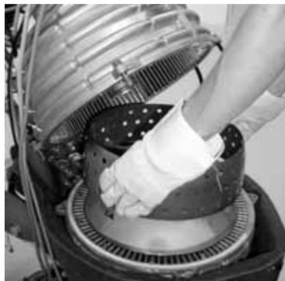
Figura 8-6 Estrazione dell'elemento refrattario superiore (nella figura A1 BG 25i)
