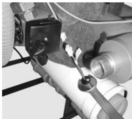
Figura 5-13 Allentare lo spinotto per la sonda di temperatura fumi    Figura 5-14 Svitare ed estrarre la sonda di temperatura fumi
