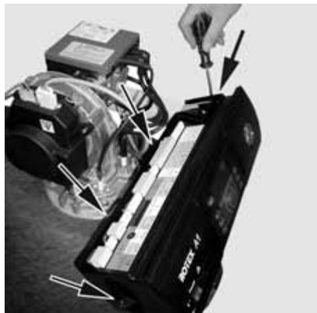
Figura 5-15 Rimozione dei tappi a vite della copertura del quadro di comando
