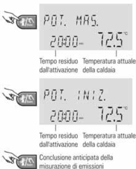
Figura 13-2 Istruzioni brevi per il funzionamento in modalità Spazzacamino
