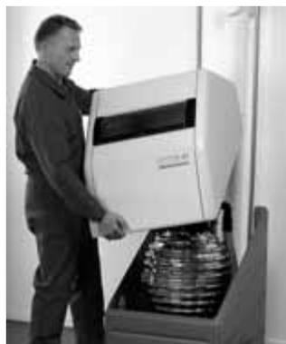
Figura 8-1 Rimozione della cappa insonorizzante
