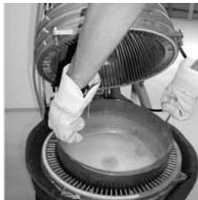
Figura 8-7 Estrazione dell'elemento refrattario inferiore (nella figura A1 BG 25i)
