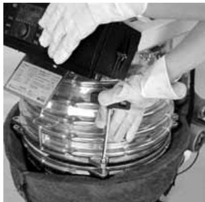
Figura 8-4 Apertura della camera di combustione
