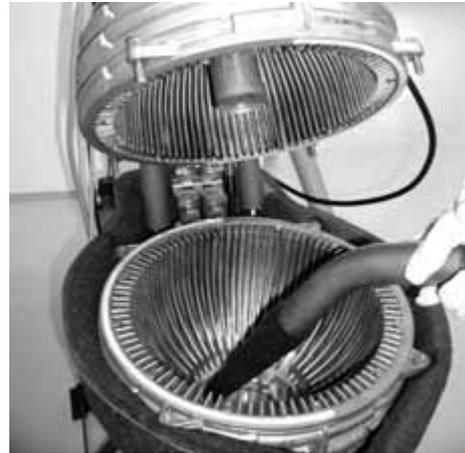
Figura 8-8 Pulizia della camera di combustione
