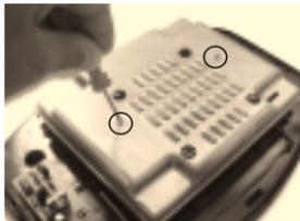
3) sostituire la batteria facendo attenzione alle polarità
