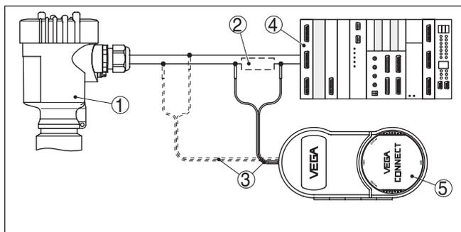
Figura 29: Collegamento del PC via HART alla linea del segnale
