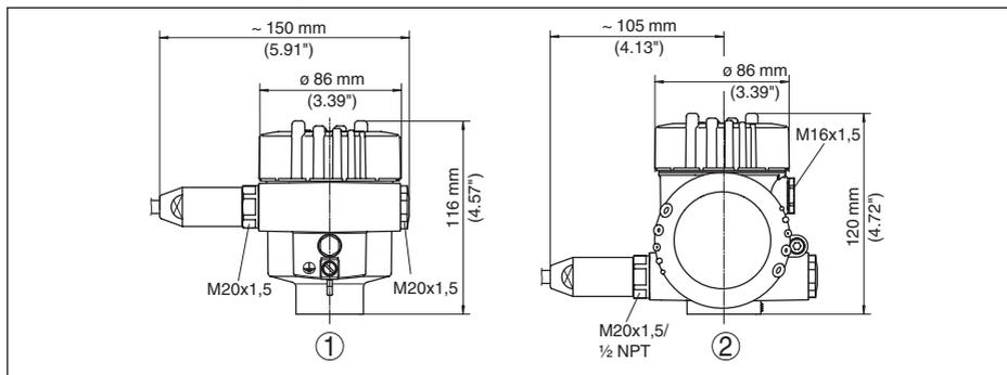
Figura 50: Le differenti custodie con grado di protezione IP 66/IP 68 (1 bar) - con tastierino di taratura con display incorporato l'altezza della custodia aumenta di 9 mm/0.35 in
