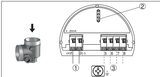
Figura 15: Vano dell'elettronica custodia a due camere Ex d ia
