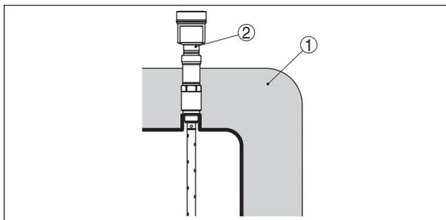
Figura 7: Montaggio dell'apparechio su un serbatoio isolato.
