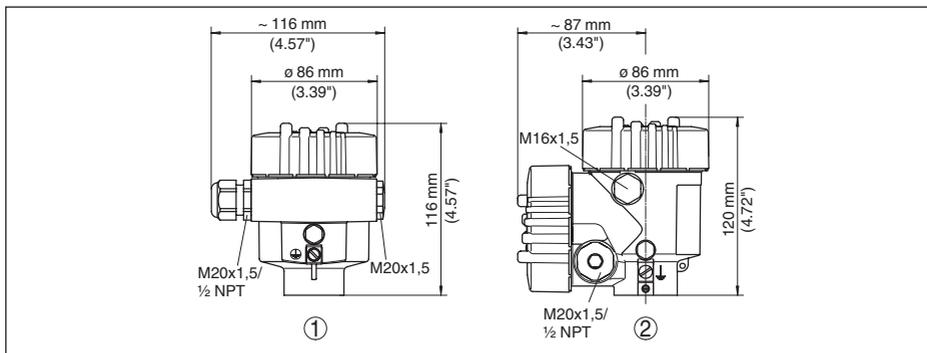
Figura 49: Le differenti custodie con grado di protezione IP 66/IP 68 (0,2 bar) - con tastierino di taratura con display incorporato l'altezza della custodia aumenta di 9 mm/0.35 in
