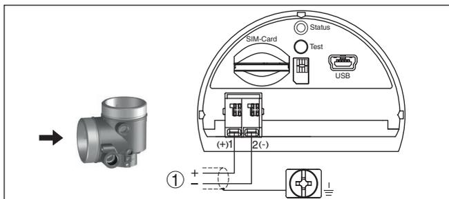
Figura 14: Vano di connessione modulo radio PLICSMOBILE
