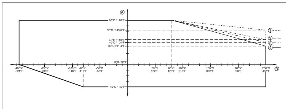
Figura 47: Temperatura ambiente - temperatura di processo, esecuzione standard
