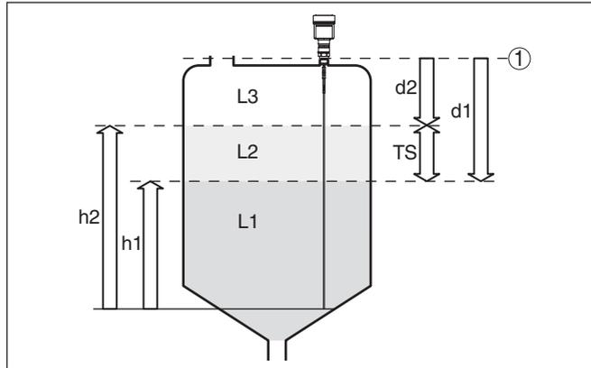
Figura 3: Misura d'interfaccia
