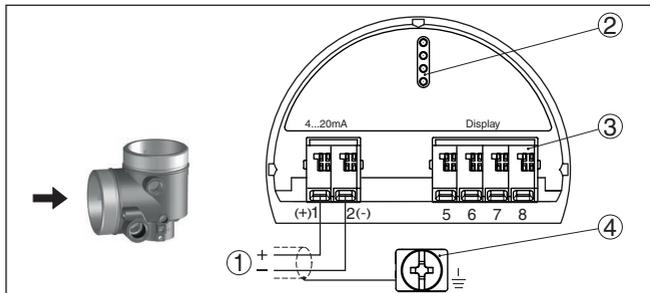
Figura 13: Vano di allacciamento custodia a due camere
