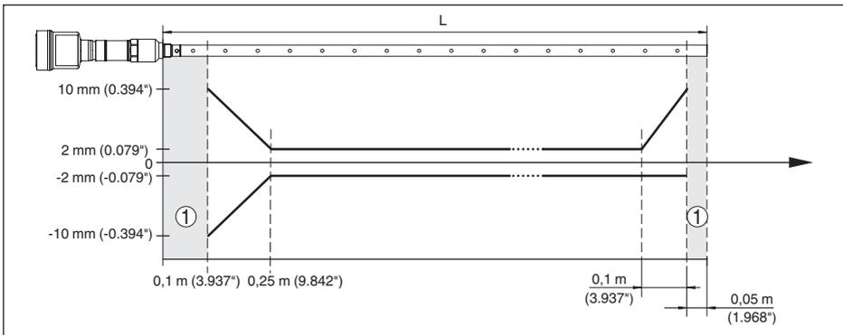
Figura 45: Scostamento di misura VEGAFLEX 86 in esecuzione coassiale su olio - lunghezza di misura fino a 1,5 m (4.92 ft)
