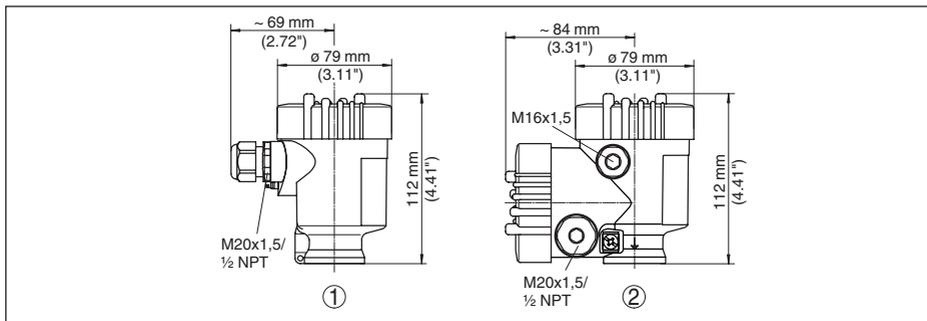
Figura 48: Custodie con grado di protezione IP 66/IP 67. Con tastierino di taratura con display incorporato l'altezza della custodia aumenta di 9 mm/0.35 in
