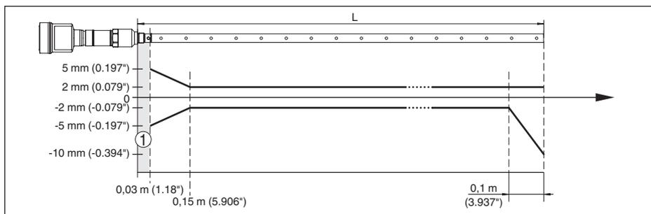
Figura 43: Scostamento di misura VEGAFLEX 86 in esecuzione coassiale su acqua - lunghezza di misura fino a 1,5 m (4.92 ft)
