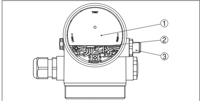
Figura 19: Vista sul vano dell'elettronica con DISADAPT per il collegamento dell'unità d'indicazione e di calibrazione esterna
