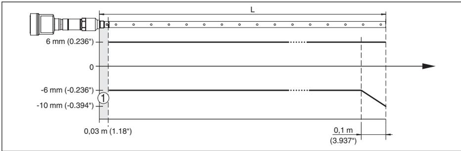
Figura 44: Scostamento di misura VEGAFLEX 86 in esecuzione coassiale su acqua - lunghezza di misura fino a 6 m (19.69 ft)
