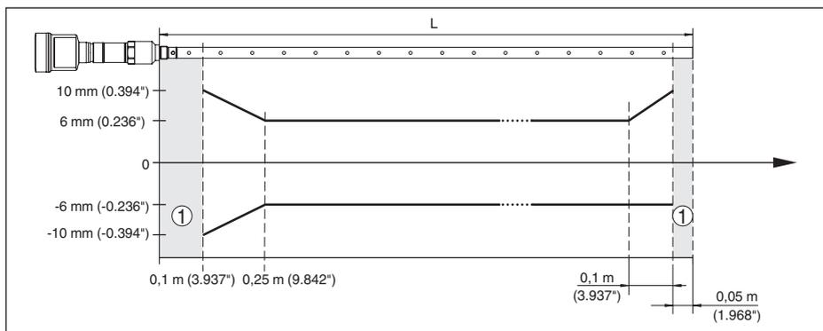
Figura 46: Scostamento di misura VEGAFLEX 86 in esecuzione coassiale su olio - lunghezza di misura fino a 6 m (19.69 ft)
