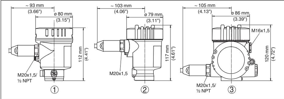
Figura 52: Le differenti custodie con grado di protezione IP 66/IP 68 (1 bar) - con tastierino di taratura con display incorporato l'altezza della custodia aumenta di 9 mm/0.35 in
