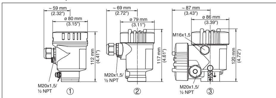
Figura 51: Le differenti custodie con grado di protezione IP 66/IP 68 (0,2 bar) - con tastierino di taratura con display incorporato l'altezza della custodia aumenta di 9 mm/0.35 in
