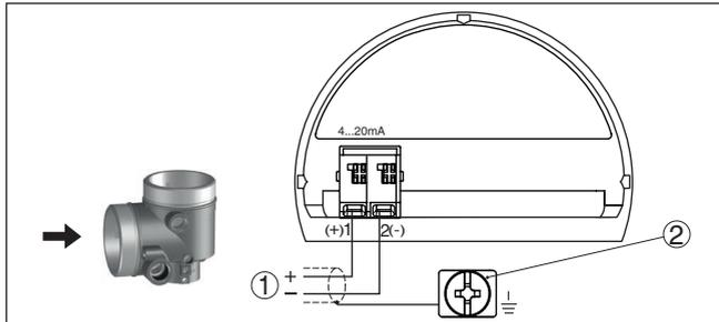
Figura 16: Vano di allacciamento custodia a due camere Ex d ia
