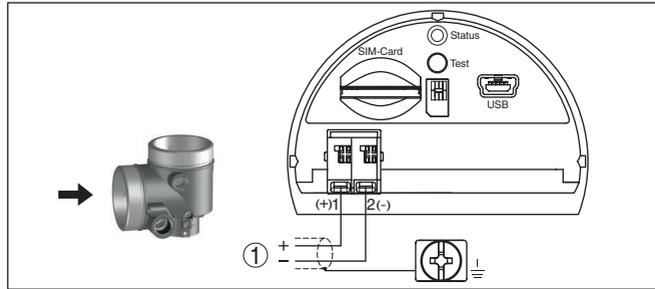
Figura 23: Vano di connessione del modulo radio integrato PLICSMOBILE
