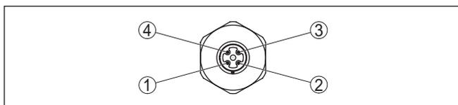
Figura 18: Vista sul connettore a spina M12 x 1
