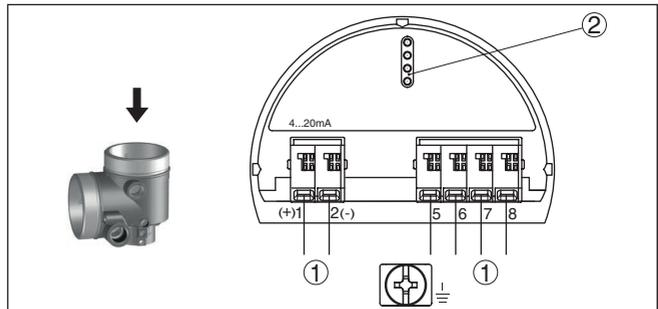
Figura 12: Vano dell'elettronica con custodia a due camere
