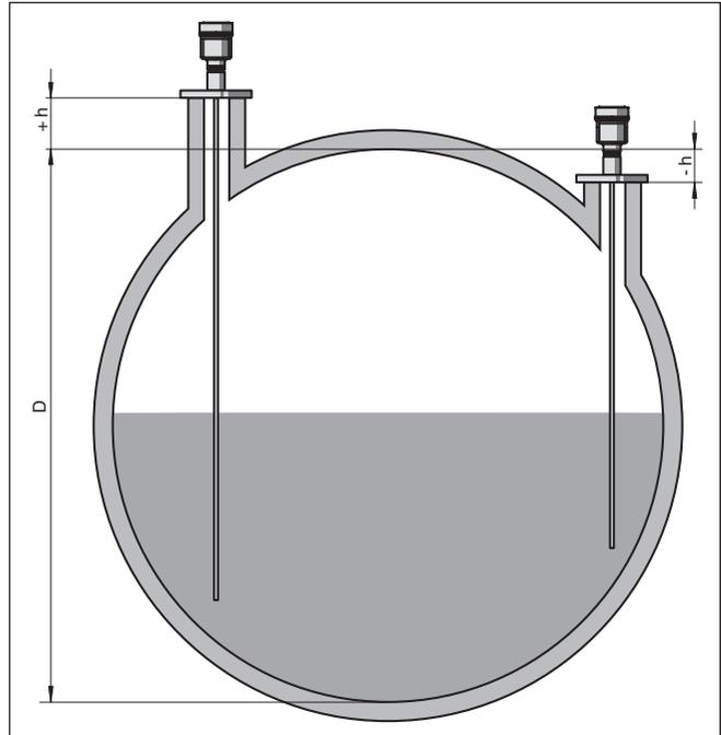
Figura 27: Altezza del serbatoio e valore di correzione tronchetto
