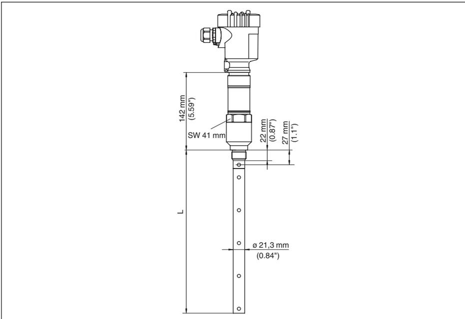
Figura 53: VEGAFLEX 86, esecuzione coassiale con filettatura (-20 ... +250 °C/-4 ... +482 °F)
