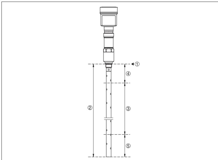
Figura 42: Campo di misura del VEGAFLEX 86 - Esecuzione coassiale
