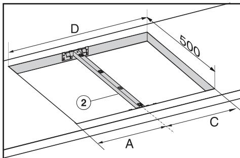
Incassando **due apparecchi** la larghezza dell'intaglio D è data dalle misure A più C.
