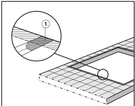
Le fessure ① e l'area tratteggiata indicata nell'immagine devono essere lisci e perfettamente in piano perché la cornice del piano di cottura appoggi bene e la guarnizione applicata sotto il bordo possa garantire sufficiente tenuta.
