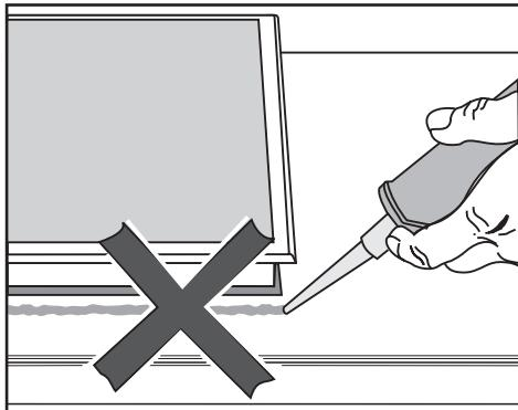
Il nastro di guarnizione sotto il bordo della parte superiore dell'apparecchio garantisce la sufficiente tenuta al piano di lavoro.
