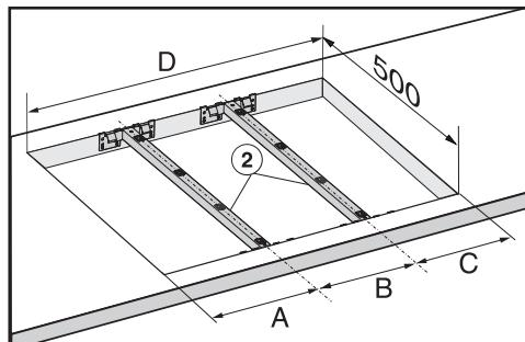
Incassando **tre apparecchi** la larghezza dell'intaglio D è data dalle misure A più B più C.
