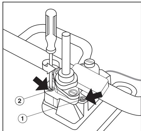
① Ugello del minimo a diametro ridotto (ad es. per gas liquido: 0,20)
