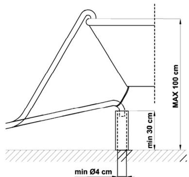
L'estremità libera andrà collocata ad un'altezza compresa tra **30 e 100 cm** e non dovrà mai trovarsi immersa nell'acqua. In presenza di tubi di prolunga disposti orizzontalmente, per un massimo di 3 m, posizionare il tubo di scarico ad un'altezza max. di **85 cm** dal suolo.
