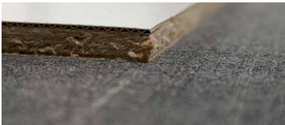
*Il progetto Mantello sviluppato da Nanosurface, spin-off del Politecnico di Milano, prevede un materiale d'imballaggio composito costituito da una matrice cellulosica derivante da sfondi produttivi, all'interno della quale sono stati integrati e dispersi omogeneamente i PCM; la struttura finale, che preserva le temperature dei prodotti ortofruttilicoli, è composta da due strati esterni di cartone ondulato e di carta kraft che avvolgono lo strato di composito.*
