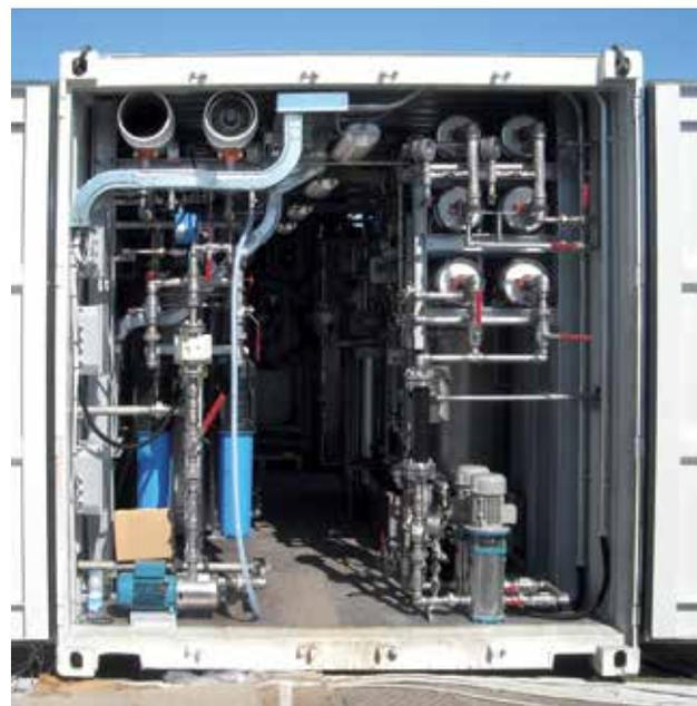
*Particolare dell'impianto di produzione azoto: compressione/essiccazione aria.*
