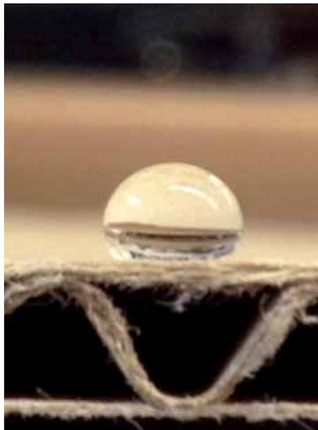
teriali lignei sia cellulosici; nel primo caso l'assorbimento in peso d'acqua si limita a un 3,6% rispetto al 19,8% di un materiale non trattato. Analoga prova di assorbimento per immersione rivela che un cartoncino (275 gr/m<sup>2</sup>) di uguale dimensione non trattato assorbe fino al 50% in peso di acqua, mentre uno trattato con rivestimento a base alcol assorbe solo 10-13%, e uno con rivestimento a base acqua il 20-25%. I trattamenti applicati al car-
