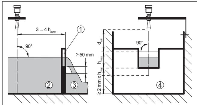
Figura 19: Misura di portata con stramazzo rettangolare:  $d_{min}$  = distanza minima del sensore (vedi capitolo "Dati tecnici");  $h_{max}$  = max. riempimento dello stramazzo rettangolare
