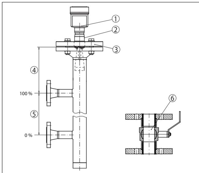
Figura 18: Struttura del bypass
