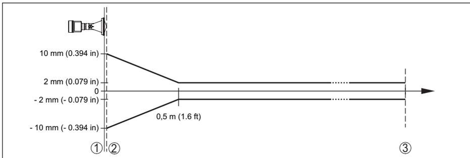
Figura 57: Scostamento di misura sotto condizioni di riferimento - antenna a cono di resina
