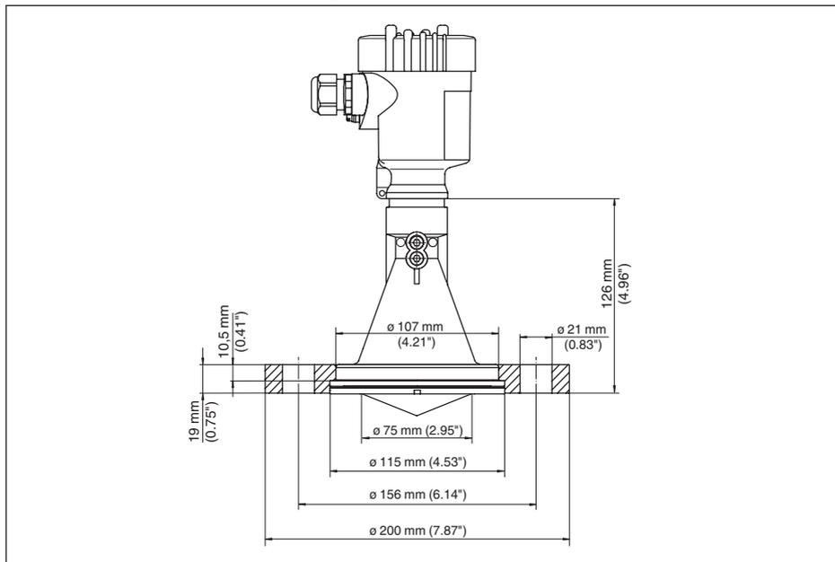
Figura 71: VEGAPULS 61, flangia di raccordo adatta a DN 80 PN 16/ASME 3" 150lbs/JIS80 10K
