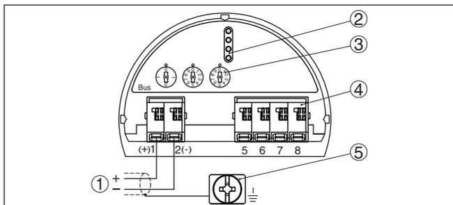
Figura 23: Vano dell'elettronica e di connessione della custodia ad una camera
