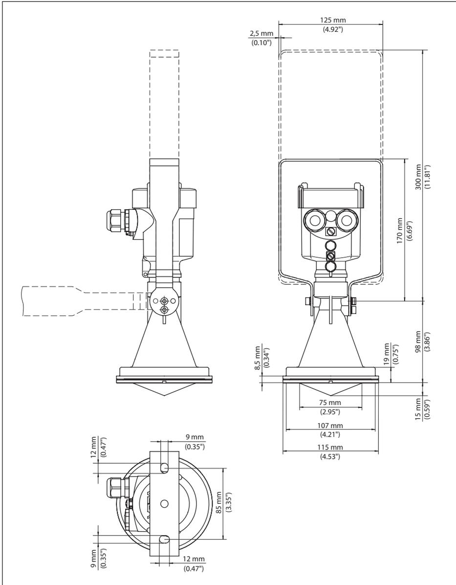
Figura 68: VEGAPULS 61, staffa di montaggio lunga 170 o 300 mm
