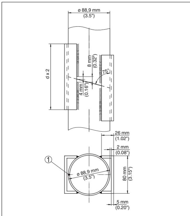
Figura 17: Saldatura per prolungamento del tubo di calma per diversi esempi di diametro
