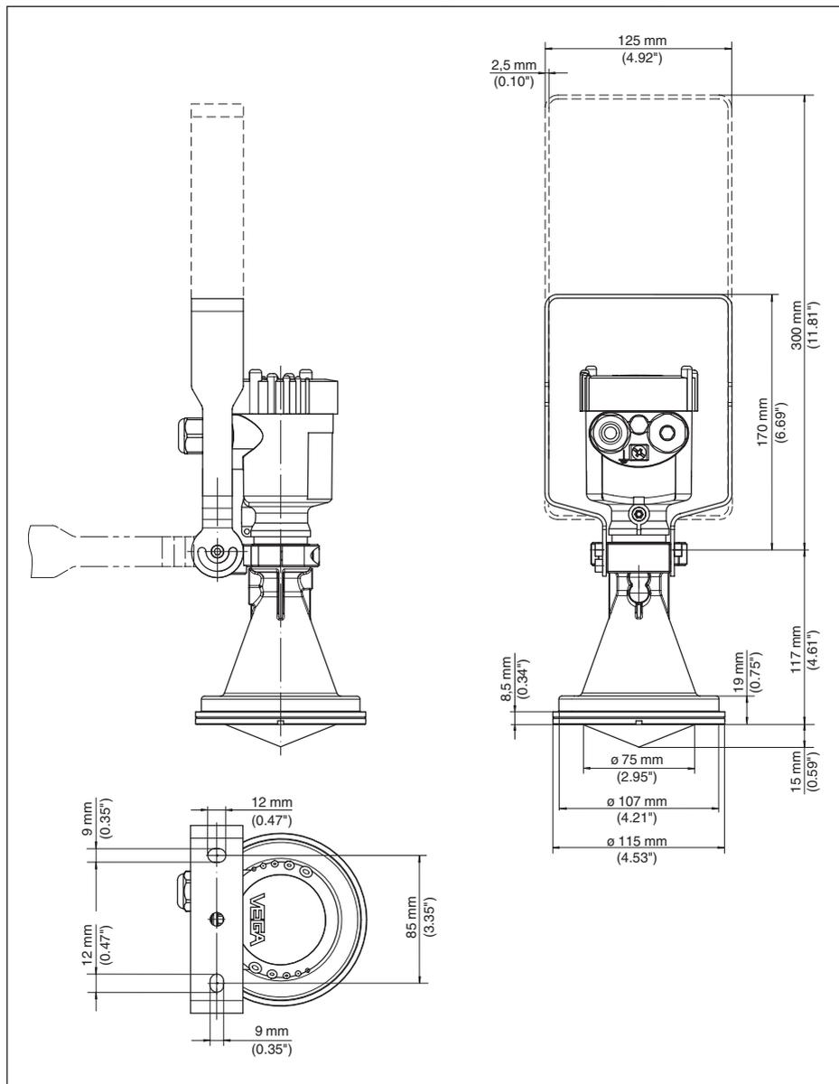
Figura 69: VEGAPULS 61, staffa di montaggio lunga 170 o 300 mm
