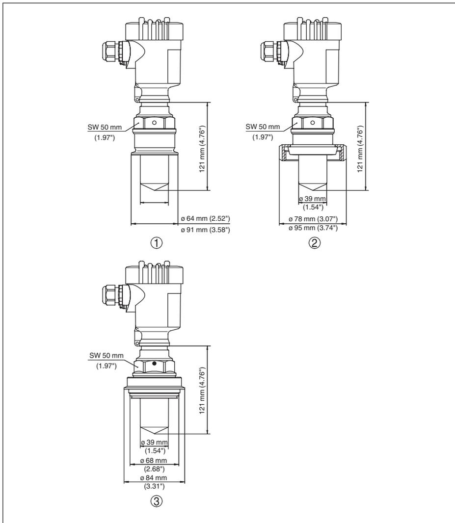
Figura 67: VEGAPULS 61, attacco asettico
