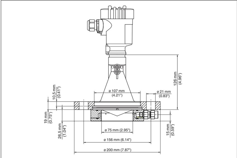
Figura 72: VEGAPULS 61, flangia di raccordo con attacco per spurgo, adeguata a DN 80 PN 16/ASME 3" 150lbs/JIS80 10K
