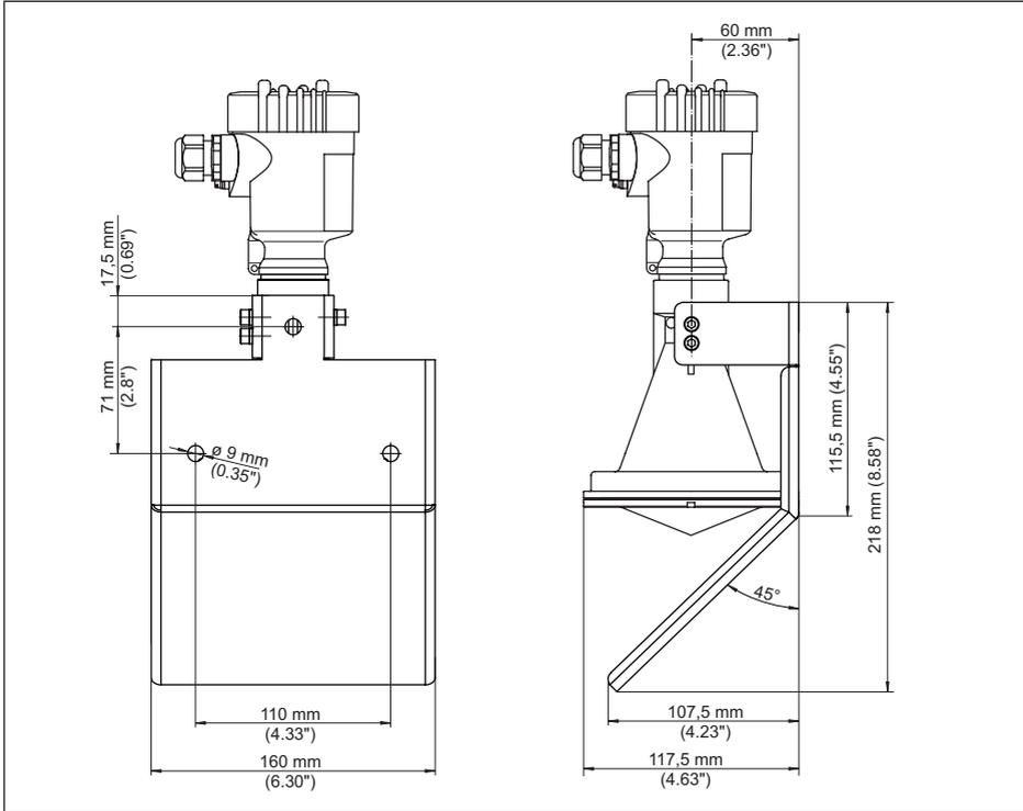
Figura 70: VEGAPULS 61, staffa di montaggio e riflettore
