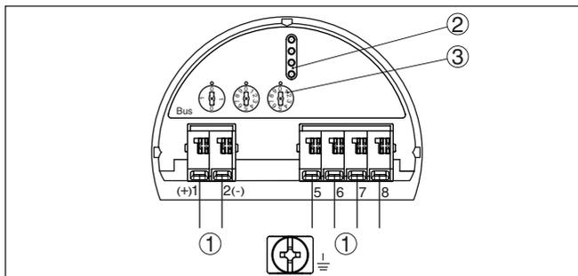
Figura 24: Vano dell'elettronica con custodia a due camere
