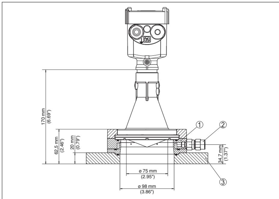
Figura 74: VEGAPULS 61, flangia di adattamento con lavaggio ad aria
