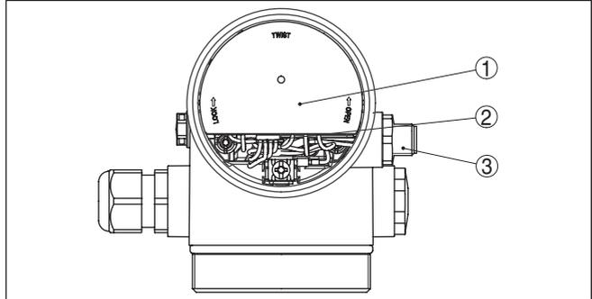
Figura 30: Vista sul vano dell'elettronica con DISADAPT per il collegamento dell'unità d'indicazione e di calibrazione esterna
