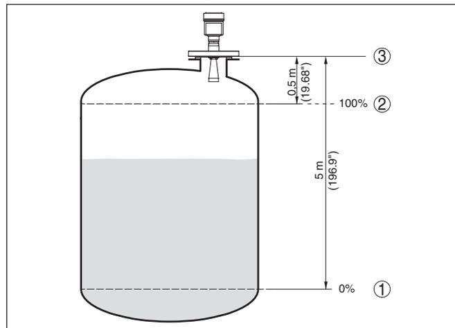
Figura 37: Esempio di parametrizzazione Taratura di min./max.
