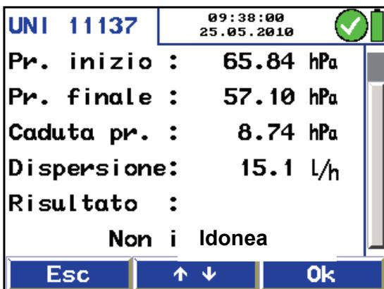
Imm. 44: Il risultato della prova di tenuta metodo indiretto
