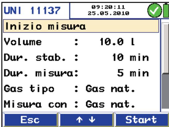
Imm. 39: prima parte del display della prova di tenuta UNI 11137-1 metodo indiretto
