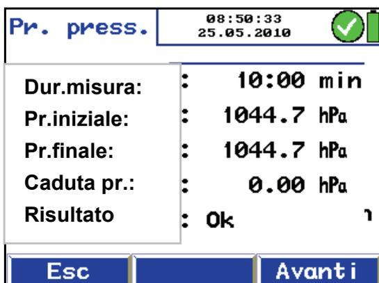
Imm. 24: Risultato della prova di pressione
