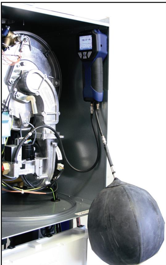
*Imm. 3: Tubo di collegamento del Wöhler DC 430 per la misure perdite con serbatoio morbido pieno.*
