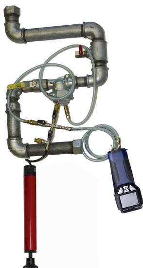
Imm. 50: Misura manuale del volume con pompa nerofumo e speciale crociera per contatore gas monoattacco
