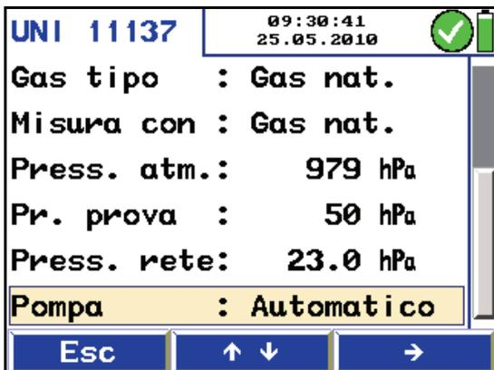
Imm. 40: seconda parte del display della prova di tenuta UNI 11137-1 metodo indiretto
