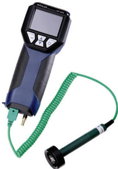
*Imm. 7: Collegamento di una sonda temperatura superfici per il calcolo del valore U dei muri*
