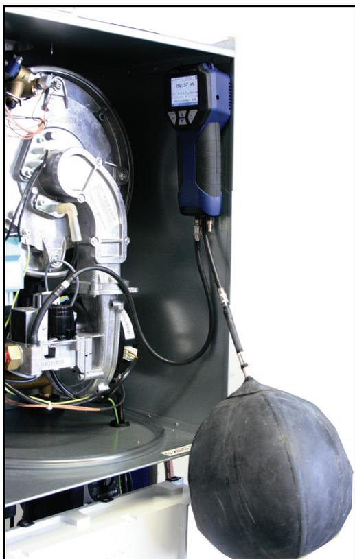
Imm. 32: Collegamento del serbatoio gas al DC 430 attraverso un tubo e raccordo, nonché del DC 430 al raccordo della tubazione gas.
