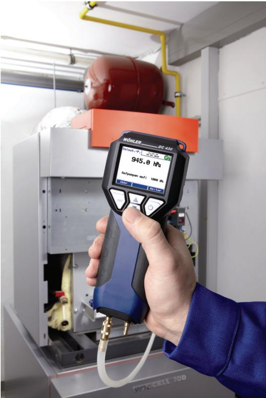
Imm. 25: DC 430 collegato attraverso un tubo direttamente al raccordo tubazione gas
