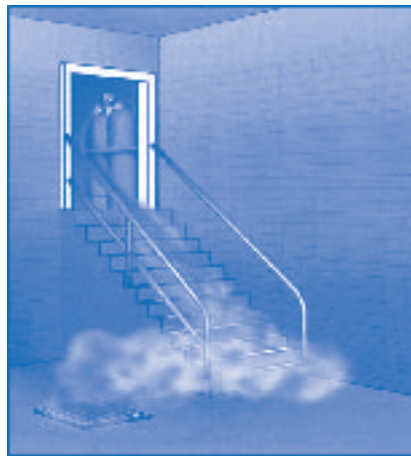
Figura 2.3: Modalità di propagazione dei gas liquefatti (esempio). 6
