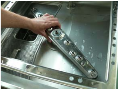
Rimontare il braccio di lavaggio inferiore
