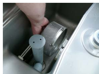
Estrarre il filtro aspirazione pompa
