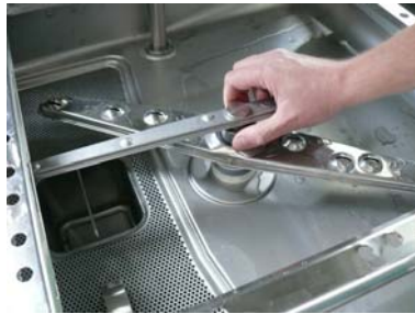
Riavvitare il braccio di risciacquo inferiore
