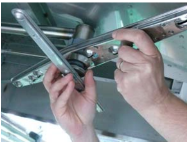
Tenendo con una mano il braccio di lavaggio in posizione, avvitare il braccio di risciacquo .
