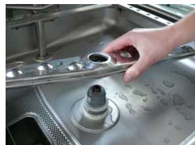
Estrarre il mulinello di lavaggio inferiore
