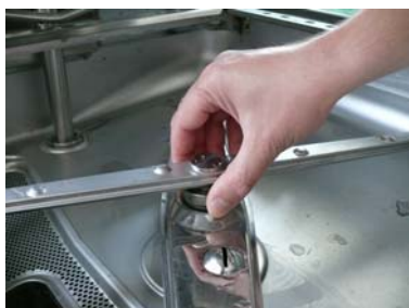
Svitare il mulinello di risciacquo inferiore
