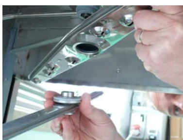
Estrarre il mulinello di lavaggio superiore
