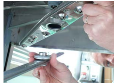
Montare il braccio di lavaggio superiore
