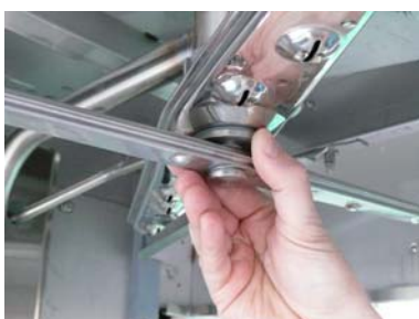
Svitare il mulinello di risciacquo superiore
