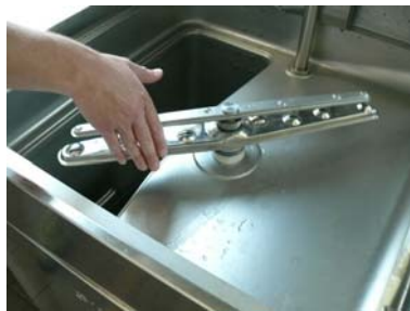
Controllare che i bracci di lavaggio e risciacquo siano liberi di ruotare (inferiori e superiori)
