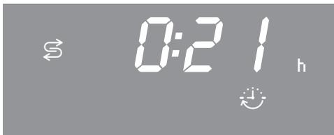
L'indicazione del tempo viene corretta automaticamente a seconda dell'effettiva quantità di acqua residua presente.
