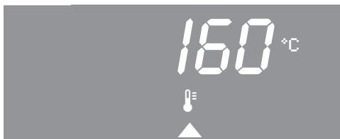
Vengono attivati il riscaldamento del vano cottura, l'illuminazione e la ventola di raffreddamento.
