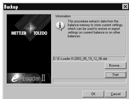
Il dialogo qui accanto richiede di scegliere il percorso per il salvataggio dei dati tramite l'area "Browse". Come nome per il backup di dati, e-Loader II propone una combinazione della data e dell'ora attuale, e l'estensione ".dat" (esempio: "2003\_08\_19\_12\_06.dat" per un backup di dati realizzato il 12 agosto 2003 alle 12.06). Se necessario, è possibile cambiare il nome del file, ma non l'estensione ".dat".
