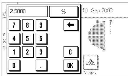
Con i tasti funzione "**+Tol**" e "**-Tol**" è possibile stabilire la precisione con cui si effettua il dosaggio. La finestra di inserimento è uguale a quella del peso nominale. All'origine, i valori di tolleranza sono impostati su 2.5%.
