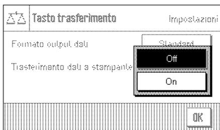
Premendo il tasto funzione **"Transfer"** i dati vengono solitamente trasmessi solo all'host. Se si desidera inviare i dati anche alla stampante, si dovrà attivare l'impostazione **"Trasferimento dati a stampante"**. **Nota:** le impostazioni descritte in precedenza per la formattazione dei dati non hanno alcun influsso sulla trasmissione di dati alla stampante, questa viene stabilita esclusivamente attraverso le impostazioni dello scontrino (sezione 6.2.7).
