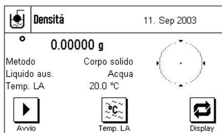
Dopo la scelta dell'applicazione appare quanto indicato a lato. I tasti funzione e i campi informazione relativi alla determinazione della densità sono attivati all'origine. La bilancia è preimpostata per la determinazione della densità di corpi solidi utilizzando acqua come liquido ausiliario. È possibile adattare queste impostazioni alle esigenze personali, seguendo le istruzioni nei prossimi capitoli.
