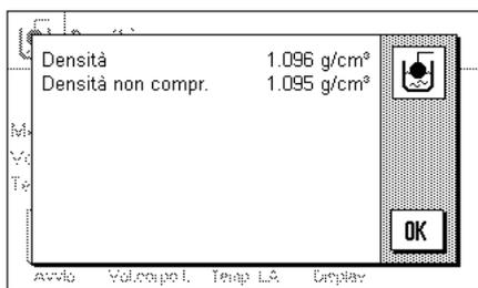
La bilancia determina la densità del liquido e visualizza il risultato (valore compensato o non compensato, a seconda delle impostazioni relative all'emissione del risultato, ved. Sezione 9.3.5).
