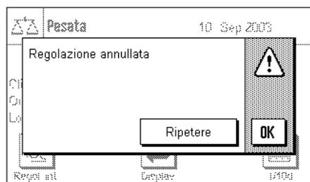
**Durante la regolazione si è verificato un errore e il processo è stato bloccato.** Questo messaggio compare anche se si decide di interrompere la regolazione. È possibile ripetere il processo di regolazione o tornare all'applicazione premendo "OK".
