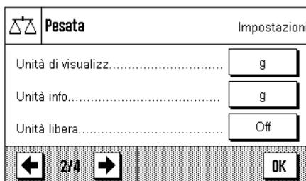
**"Unità di visualizz.":** Stabilisce l'unità per la visualizzazione del risultato (Sezione 6.2.5).
