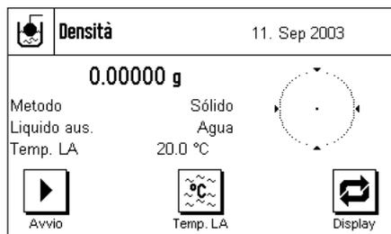
Selezionare, nelle impostazioni specifiche, il metodo "Corpi solidi" (Sezione 9.3.2) e determinare il liquido ausiliario desiderato (Sezione 9.3.3).
