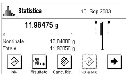
Una volta inseriti il valore nominale e le tolleranze, sul display appare la guida grafica per i dosaggi ("SmartTrac") con i limiti di tolleranza, utile per il dosaggio sulla base del valore nominale: È possibile dosare i campioni approssimativamente fino al raggiungimento della tolleranza inferiore, per poi, all'occorrenza, dosare precisamente fino al valore nominale.
