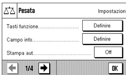
**"Tasti funzione":** Con questo si stabilisce quali tasti funzione devono comparire sul bordo inferiore del display. Questi tasti permettono di accedere direttamente alle relative funzioni (Sezione 6.2.2).
