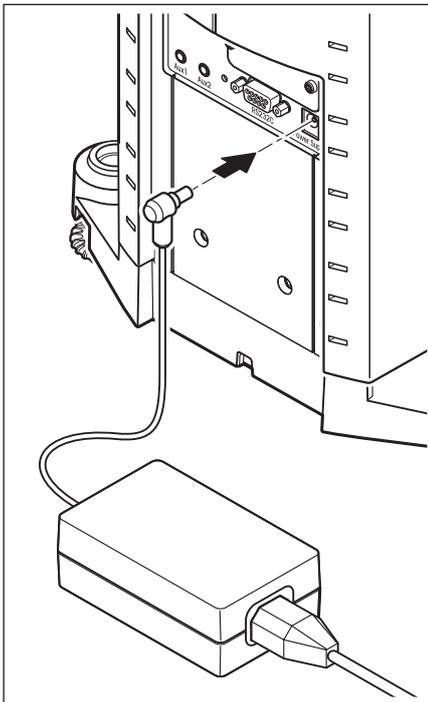
La bilancia è fornita con un alimentatore e un cavo di collegamento secondo specifiche locali. L'alimentatore è adatto per tutte le tensioni di alimentazione nell'intervallo:
