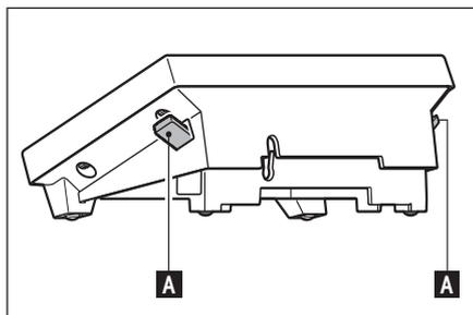
Per avere un angolo di lettura più inclinato, tirare verso l'alto entrambe le leve (A) poste sul lato. Ora è possibile tirare la parte superiore del terminale lentamente verso l'alto, finché non si bloccherà nella posizione desiderata. Esistono 3 posizioni di regolazione.
