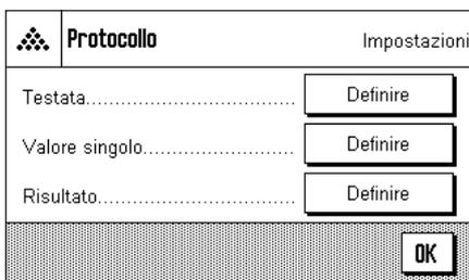
All'interno dei tre sottomenu in cui si stabiliscono le opzioni della riga di testata dello scontrino, della registrazione dei valori singoli e del risultato, sono disponibili ulteriori impostazioni specifiche del conteggio pezzi, descritte di seguito.
