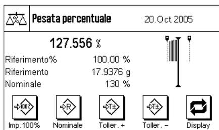
Non appena sono state inseriti il nominale e le tolleranze, verranno visualizzati i limiti di tolleranza per la guida grafica ("SmartTrac"). I limiti di tolleranza facilitano il dosaggio verso un valore nominale: in questo modo è possibile effettuare un dosaggio approssimativo del materiale finché non si raggiunge la tolleranza inferiore e poi, se necessario, effettuare un dosaggio accurato per raggiungere il nominale.
