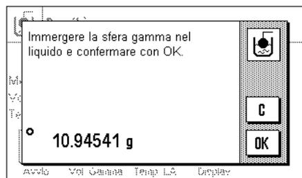
Dopo la taratura del campione verrà richiesto di immergere la sfera gamma nella sostanza campione.
