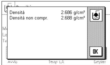
La bilancia determina la densità del corpo solido e visualizza il risultato (valore compensato o non compensato, a seconda delle impostazioni relative all'emissione del risultato, ved. Sezione 9.3.5).
