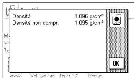
La bilancia determina la densità della sostanza pastosa e visualizza il risultato (valore compensato o non compensato, a seconda delle impostazioni relative all'emissione del risultato, ved. Sezione 9.3.5).
