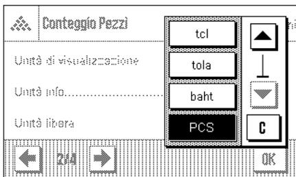
Nei menu di "Unità di visualizzazione" e "Unità Info" sono disponibili, oltre alle unità di pesata già conosciute, l'unità "PCS" (Pezzi), (premesso che sia già stato rilevato un peso del pezzo di riferimento).
