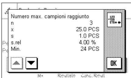
La finestra del risultato contiene i risultati della serie di conteggi (vengono visualizzate le informazioni selezionate per la documentazione dei risultati, vedi sezione 11.3.6). Si prega di seguire le informazioni della sezione 11.4.4 riguardanti le unità, la risoluzione e l'accuratezza dei valori indicati.
