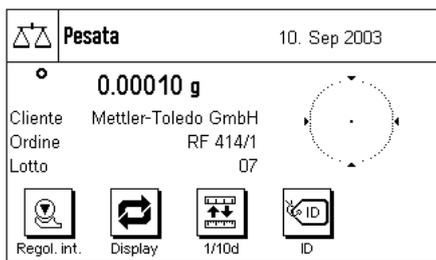
Una volta immessi tutti i dati è possibile controllare ancora una volta le identificazioni selezionate utilizzando i campi info sul display.
