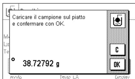
Premere il tasto funzione "Avvio" per iniziare la determinazione della densità. La bilancia effettuerà una tara automatica; poi verrà richiesto di posizionare il corpo solido (pesatura in aria).
