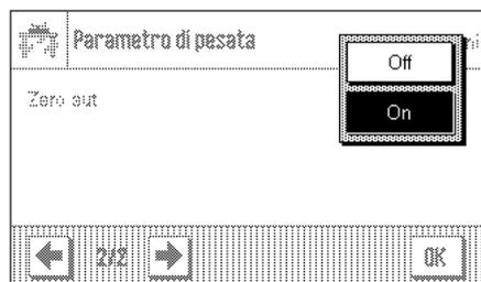
La correzione automatica del punto zero ("AutoZero") corregge costantemente qualunque oscillazione del punto zero che potrebbe verificarsi a causa, per esempio, di piccoli accumuli di sporcizia sul piatto di pesata.
