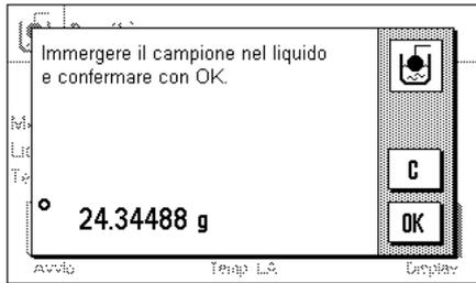
Il risultato della pesata viene memorizzato, poi viene richiesto di immergere il corpo nel liquido ausiliario.
