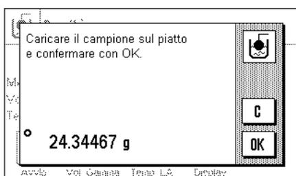
Premere il tasto funzione "Avvio" per dare inizio alla determinazione della densità. Verrà richiesto il posizionamento del campione (senza sfera gamma).
