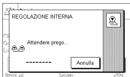
Premendo questo tasto funzione si attiva una regolazione della bilancia tramite massa di regolazione incorporata. Questa può avvenire in un momento stabilito; è possibile anche stabilire nell'impostazione di sistema che la bilancia richieda una regolazione non appena registra un cambiamento della temperatura ambientale stabilita (impostazione "CallInfo", Sezione 5.3.1).
