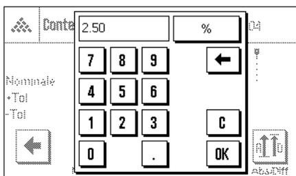
Con i tasti funzione "+Tol" e "-Tol" è possibile stabilire l'accuratezza con cui si effettua il conteggio. La finestra di inserimento è uguale a quella del peso nominale. All'origine, i valori di tolleranza sono impostati su 2,5%. Dopo l'inserimento del valore percentuale, premere "OK", per attivare la tolleranza. I conteggi che non rispettano le tolleranze vengono contrassegnati in modo particolare durante la stampa dei valori singoli (con ">T" o "<T").
