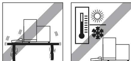
Scegliere una superficie stabile, esente da vibrazioni e il più orizzontale possibile. Il piano di appoggio deve poter sopportare il peso della bilancia a pieno carico.
