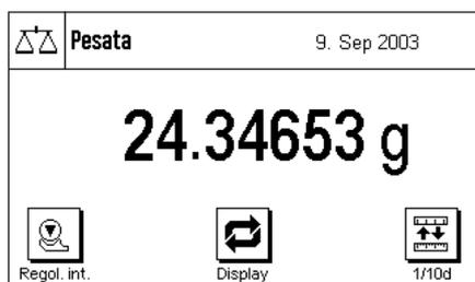
**Pesare:** Aprire il paravento in vetro, porre il materiale da pesare sulla bilancia e ri chiudere il paravento. Non appena scomparirà il simbolo di controllo stabilità (il piccolo anello a sinistra dell'indicazione del peso), il display sarà stabile e sarà possibile rilevare il risultato della pesata. Nell'illustrazione qui accanto il simbolo del controllo stabilità è ancora visibile e di conseguenza il risultato della pesata non è ancora stabile.
