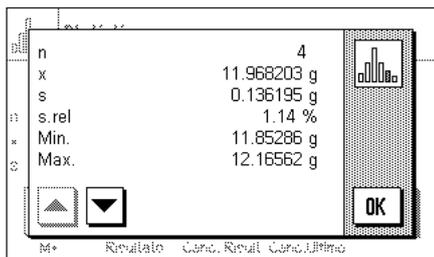
La finestra della statistica contiene i risultati della serie di pesate (vengono visualizzate le informazioni selezionate per la documentazione dei risultati, vedi Sezione 7.3.4). Si prega di seguire le informazioni del Sezione 7.4.3 riguardanti le unità, la risoluzione e la precisione dei valori indicati.
