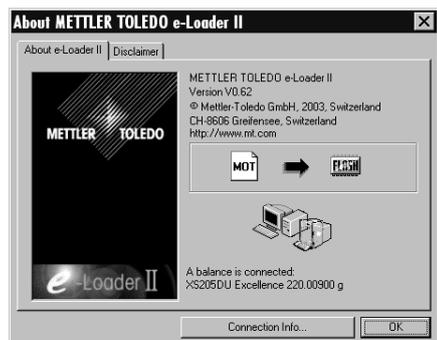
Prima di aggiornare il software della bilancia, verificare se nel menu "Help" è presente la comunicazione con la bilancia (nell'esempio a fianco è possibile vedere il messaggio di conferma, di e-Loader II, del collegamento di una bilancia).
