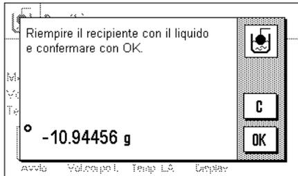
Dopo la tara del corpo a immersione, viene richiesto di versare il liquido, di cui occorre determinare la densità, in un recipiente.
