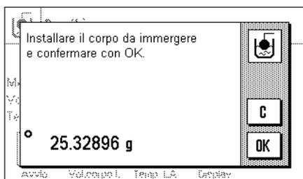
Premere il tasto funzione "Avvio", per dare inizio alla determinazione della densità. Verrà richiesta l'installazione del corpo a immersione (pesata in aria).
