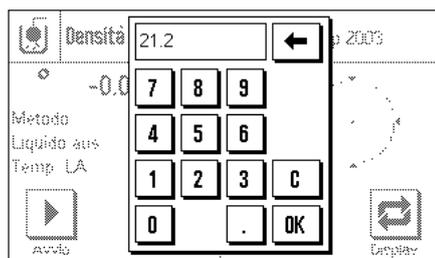
Se si utilizzano **acqua o etanolo come liquidi ausiliari**, inserire la **temperatura** tramite il tasto funzione "Temp. LA" (per entrambi i liquidi sono memorizzate, nella bilancia, le tabelle della densità in considerazione di un campo di temperature da 10 °C a 30 °C, ved. anche i Sezioni 9.7 e 9.8). La figura a fianco mostra il campo di inserimento corrispondente (inserimento in °C con 1 decimale).
