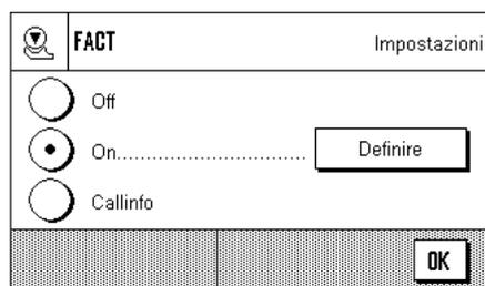
Tramite questo menu è possibile stabilire le impostazioni per la regolazione automatica con la massa di regolazione interna (FACT). FACT (**F**ully **A**utomatic **C**alibration **T**echnology) regola automaticamente la bilancia sulla base di un criterio di temperatura predefinito.
