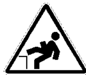
Caduta con dislivello
