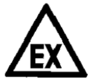
Area in cui può formarsi un'atmosfera esplosiva
