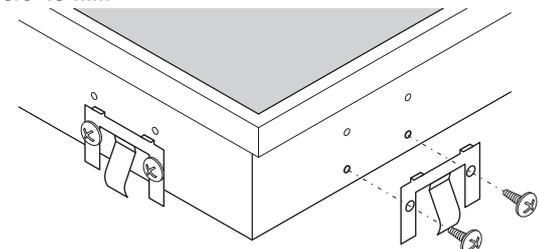
Posizionare il piano al bordo posteriore e abbassarlo con cautela. In seguito premere i clips con le mani.
