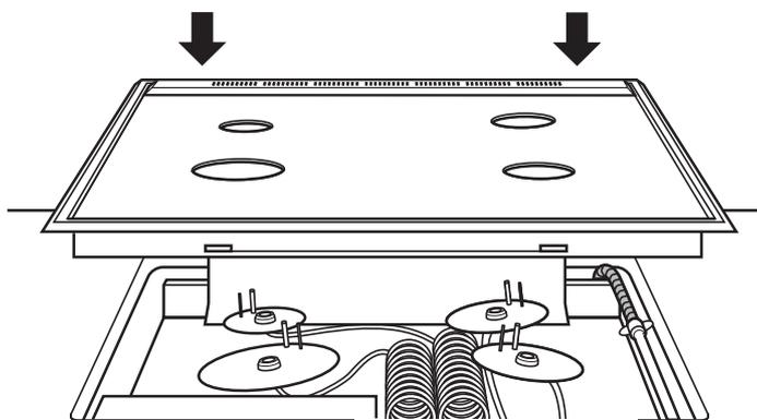
La superficie in vetroceramica deve essere piano e in modo orizzontale, perchè la superficie in ceran può rompersi se sotto tensione.
