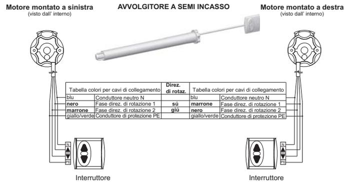
**Vista:** Cablaggio diretto tra motore ed interruttore per avvolgibili lunghezza cavi standard 3.000 mm.
