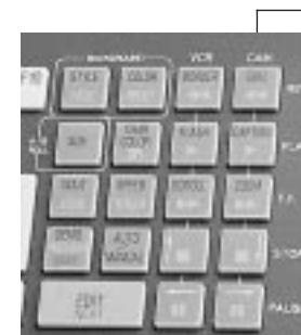
Questi tasti, durante la marcatura delle scene, consentono il completo controllo delle telecamere o videoregistratori connessi in ingresso tramite il cavetto "EDIT".
